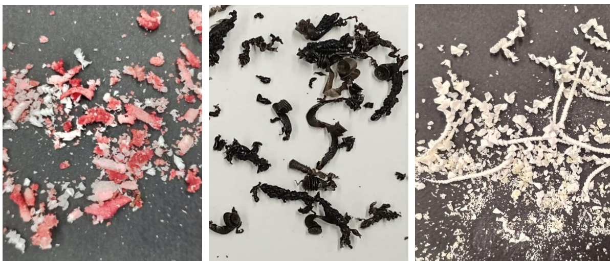
Slika 89. Odvojene čestice nastale bušenjem telećih kostiju (lijevo), PETG materijala (u sredini) i sintetske kosti proizvođača Sawbones (desno)
