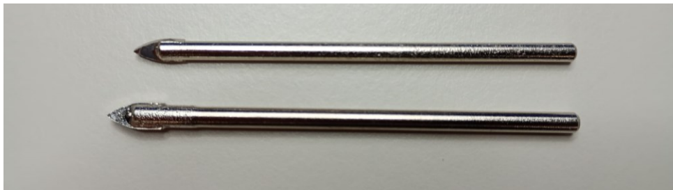
Slika 42. Svrdla bez žlijeba, s dvije oštrice
