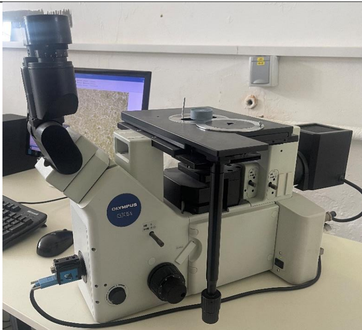
Slika 53. Svjetlosni mikroskop Olympus GX51
