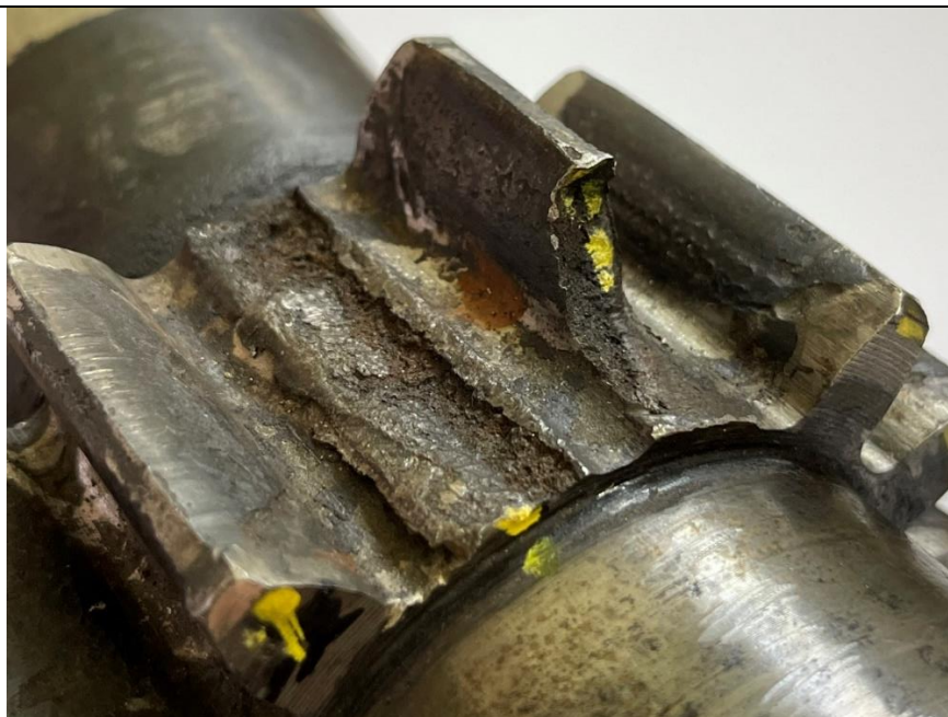
Slika 41. Detalj A: odlomljeni zubi zupčanika
