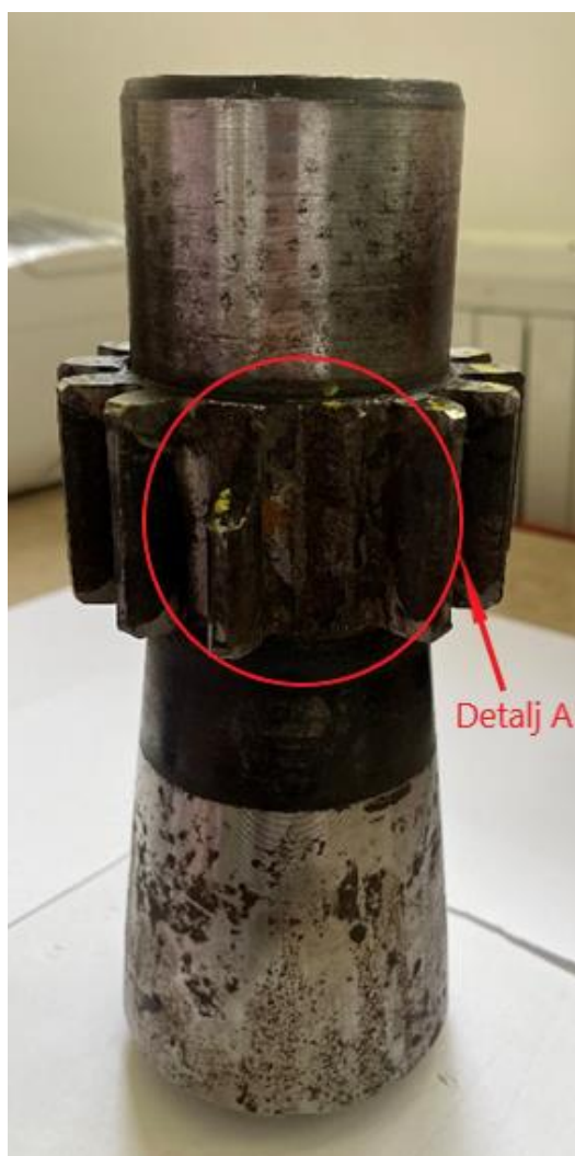
Slika 40. Analizirani zupčanik prije čišćenja i odmašćivanja
