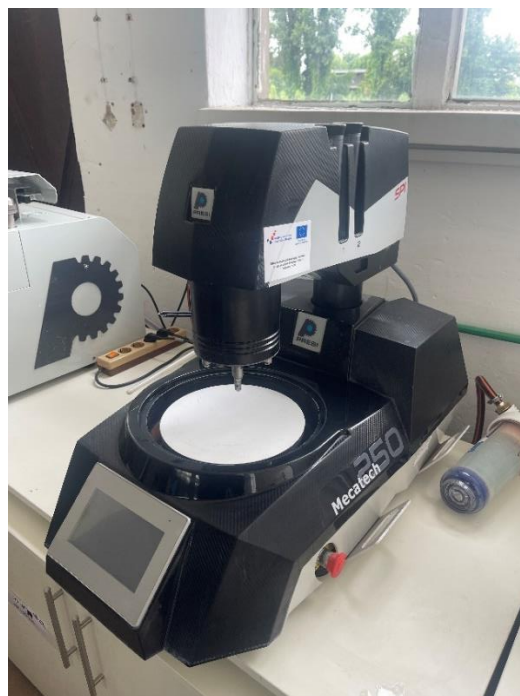
Slika 51. Uređaj za poliranje Mecatech 250
