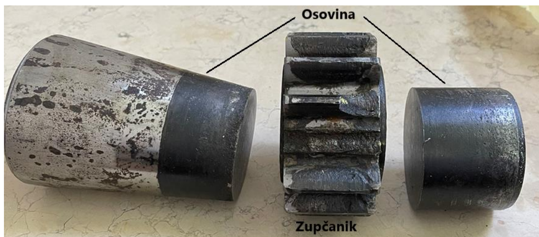
Slika 49. Odrezani zupčanik i dijelovi njegove osovine
