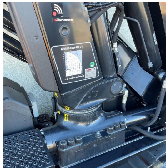
Slika 37. a) Hidraulička dizalica, b) detalj A (stup dizalice)
