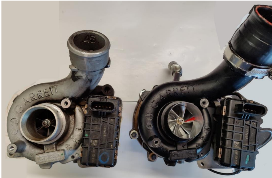
Slika 38. Usporedba stvarnih turbopunjača, strana kompresora
