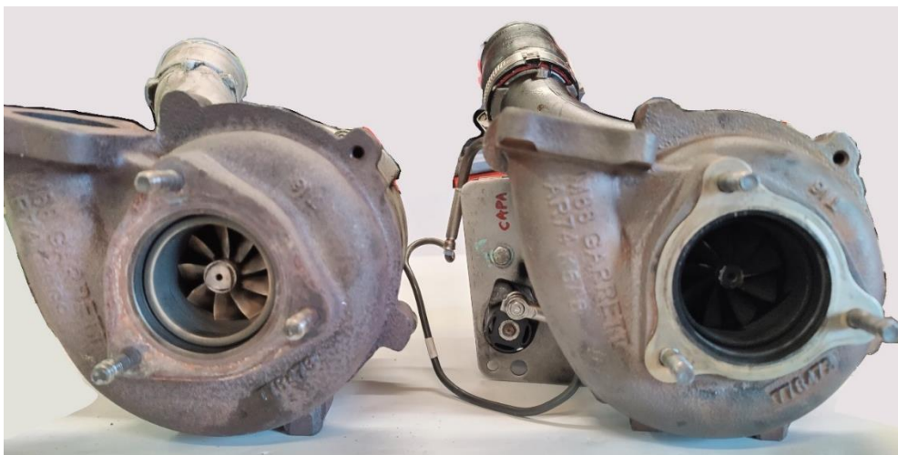
Slika 39. Usporedba stvarnih turbopunjača, strana turbine
