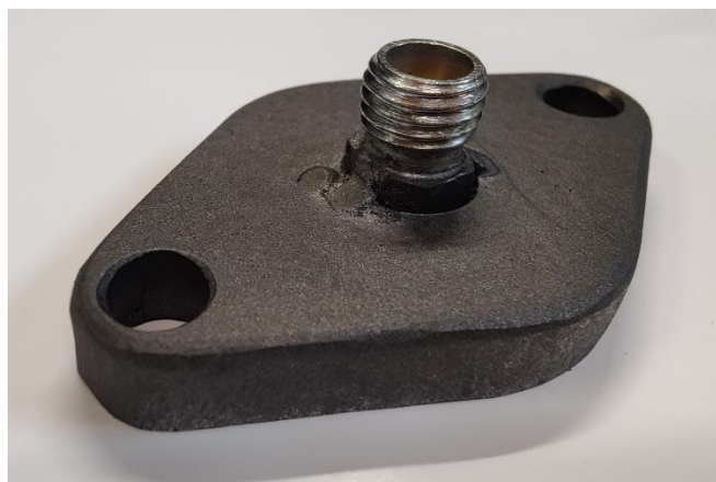
Slika 45. Pločica s prihvatom za crijevo senzora tlaka ispušnih plinova
