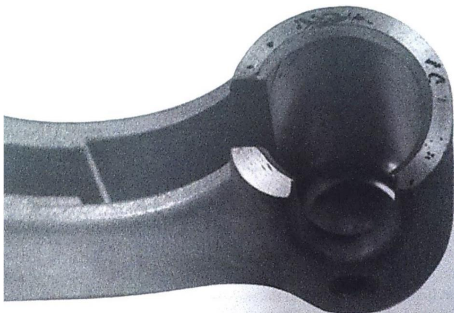
Slika 17. Tlačni aluminijski odljevak s oksidnim uključcima [15]
