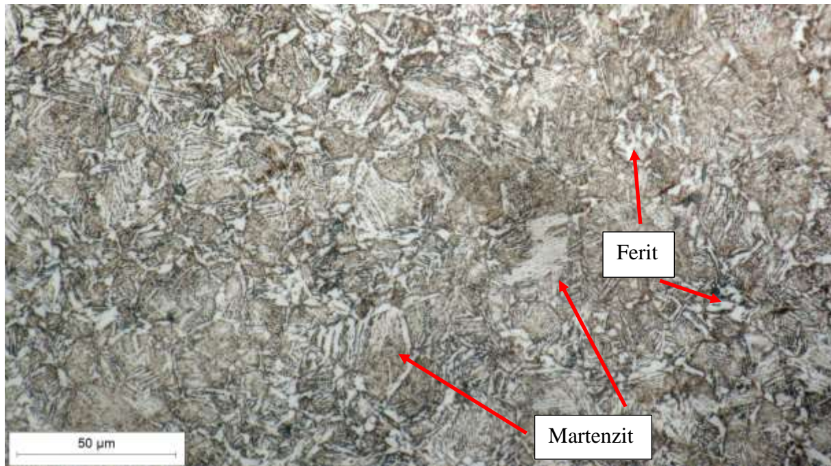
Slika 24. Mikrostruktura središnjeg dijela gonjenog zupčanika, povećanje 500x
