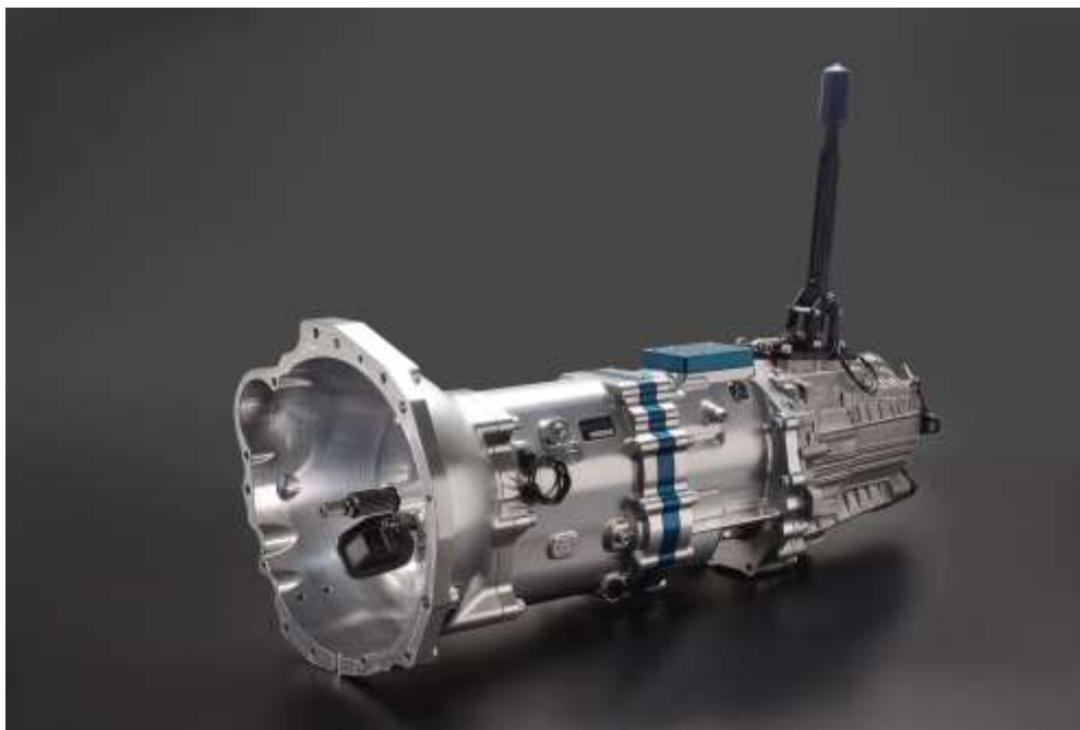
Slika 4. Kućište mjenjača i ručica mjenjača [8]
