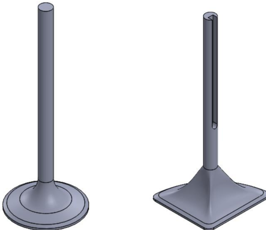
Slika 19. 3D prikaz konvencionalnog i nekonvencionalnog ventila
