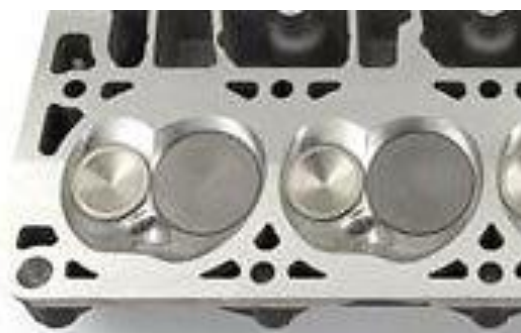
Slika 4. Glava motora s dva ventila po cilindru [7]
