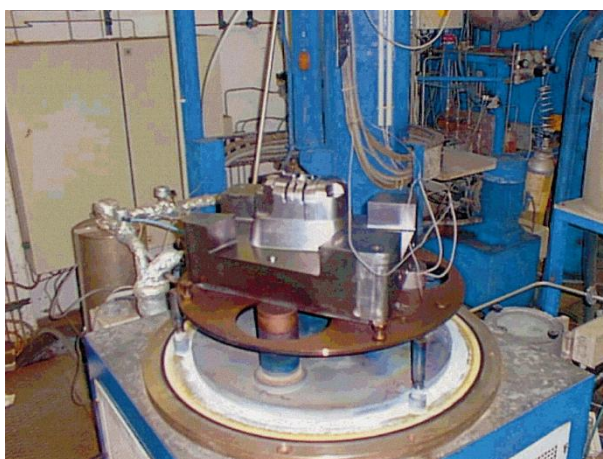
Slika 10. Polovica kalupa prevučena prevlakom TiCN-a [16]
