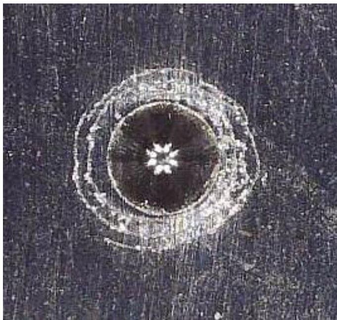
Slika 28. Otisak indentora na uzorku B2
