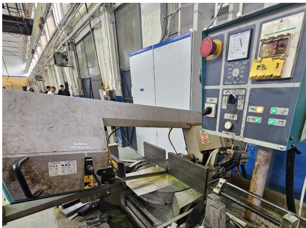
Slika 40. Rezanje uzorka tračnom pilom
