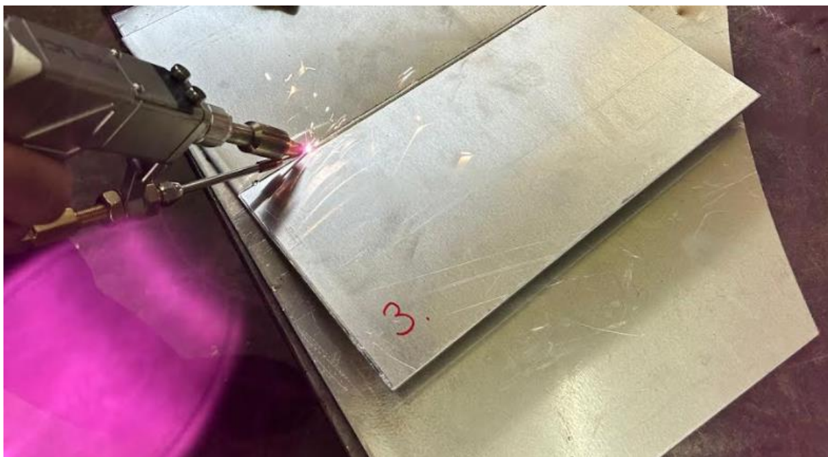
Slika 32. Zavarivanje fiber laserom uzorka 3
