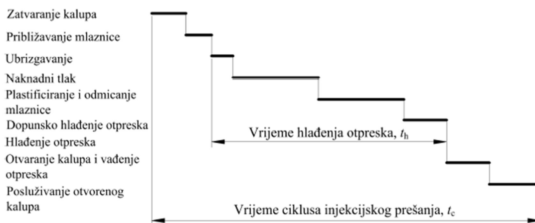
Slika 42. Vremenski dijagram injekcijskog prešanja [14]
