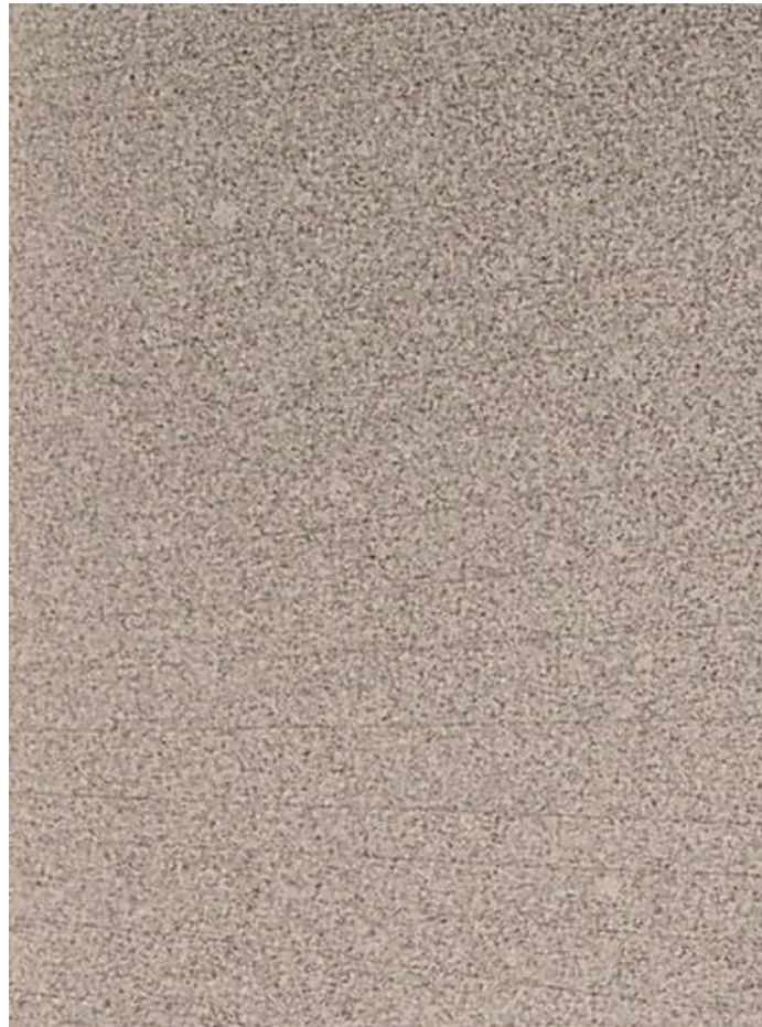
Slika 30. Indikacije na uzorku uz pretjerano čišćenje otapalom
