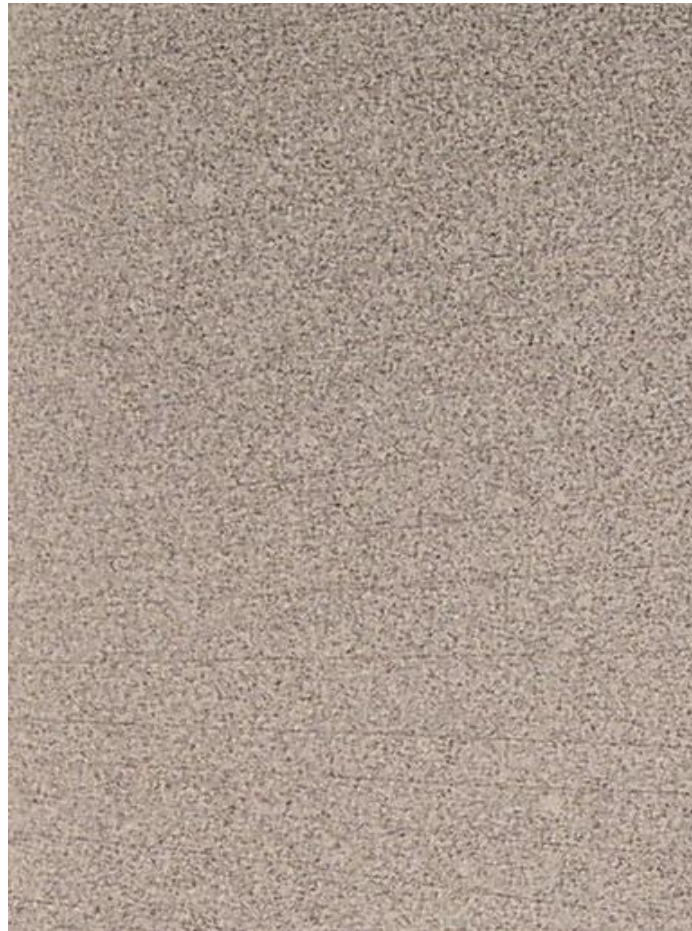
Slika 30. Indikacije na uzorku uz pretjerano čišćenje otapalom
