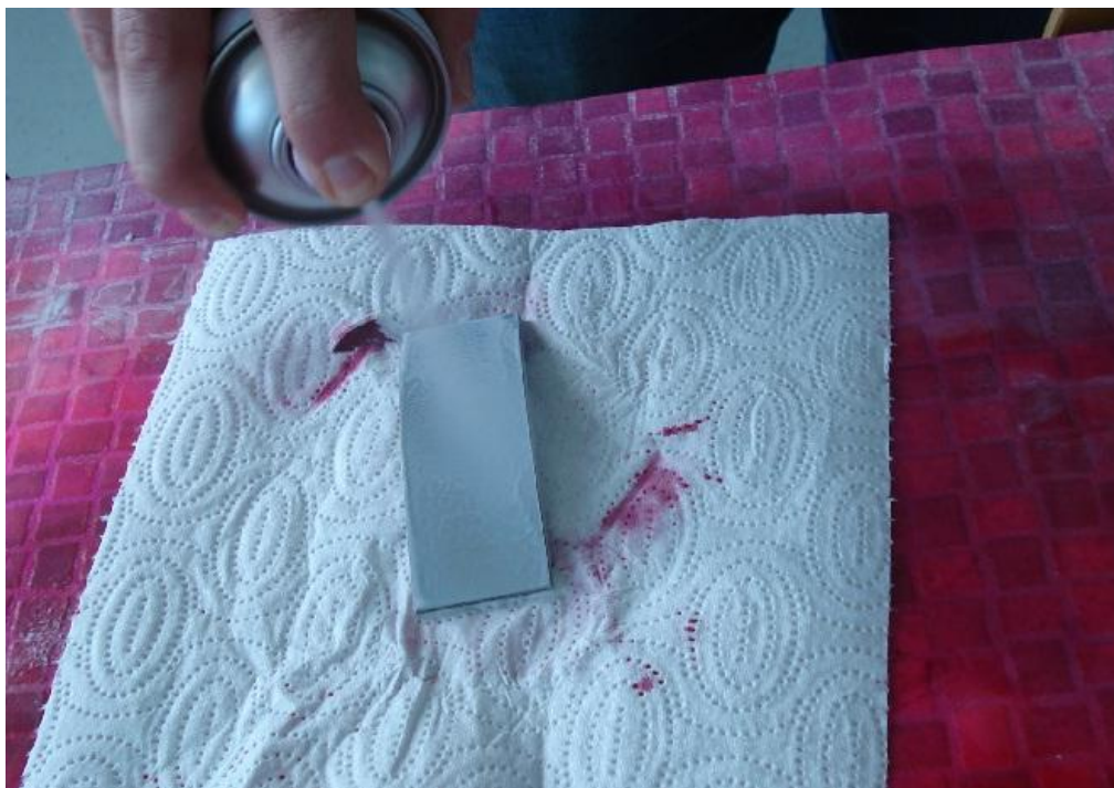
Slika 34. Nanošenje prevelike količine penetranta
