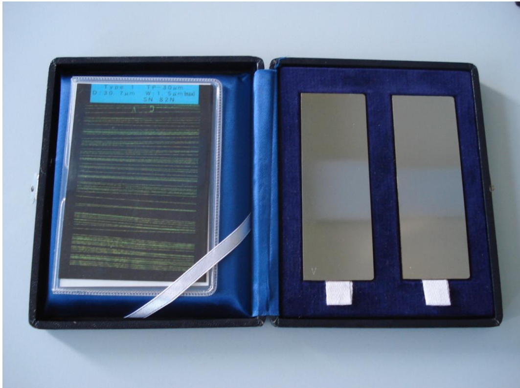
Slika 6. Jedan par pločica Tip 1 prema EN ISO 3452-3 [11] (desno), s pripadajućom slikom indikacija (lijevo)
