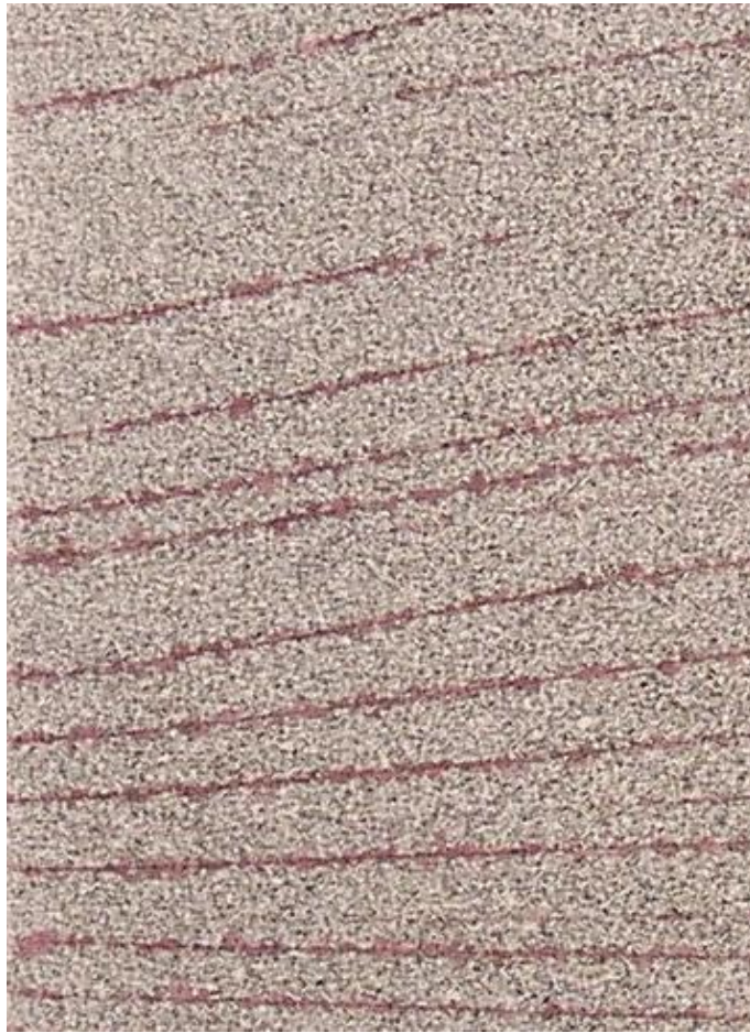
Slika 31. Indikacije na uzorku uz čišćenje tekućom vodom
