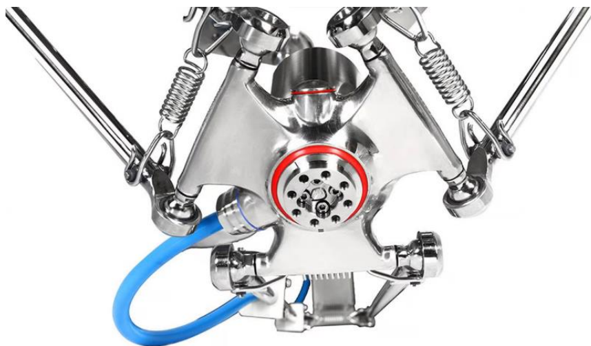
Slika 9. Konstrukcijska izvedba sfernih zglobova kod KUKA KR Delta robota [4]
