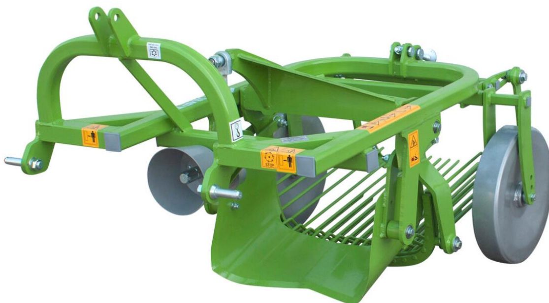
Slika 13. Bomet Ursa Z655/1 stražnje izbacivanje zamaknuta verzija [8]
