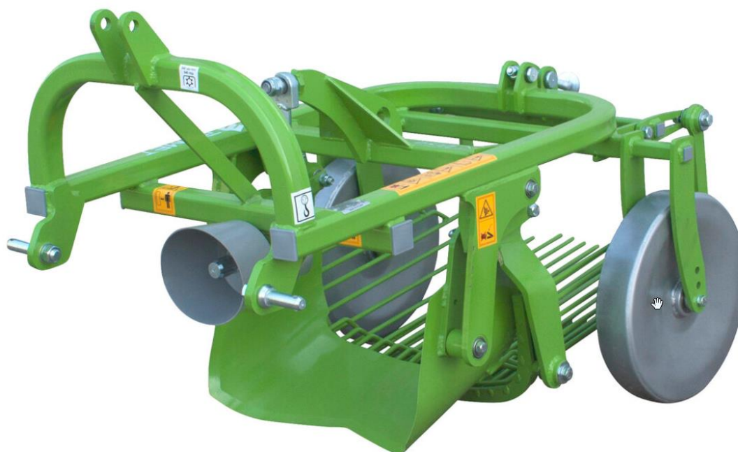
Slika 12. Bomet Ursa Z655/1 stražnje izbacivanje [8]
