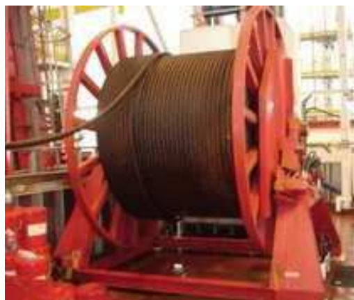
Slika 19: Kotur sa rezervnim bušnim užetom [6]
