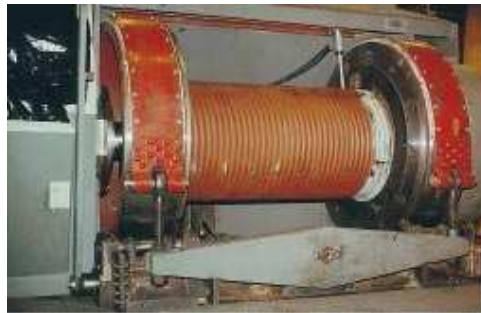
Slika 6: Bubanj dizalice s tarnim pojasevima na kočnim bubnjevima [2]
