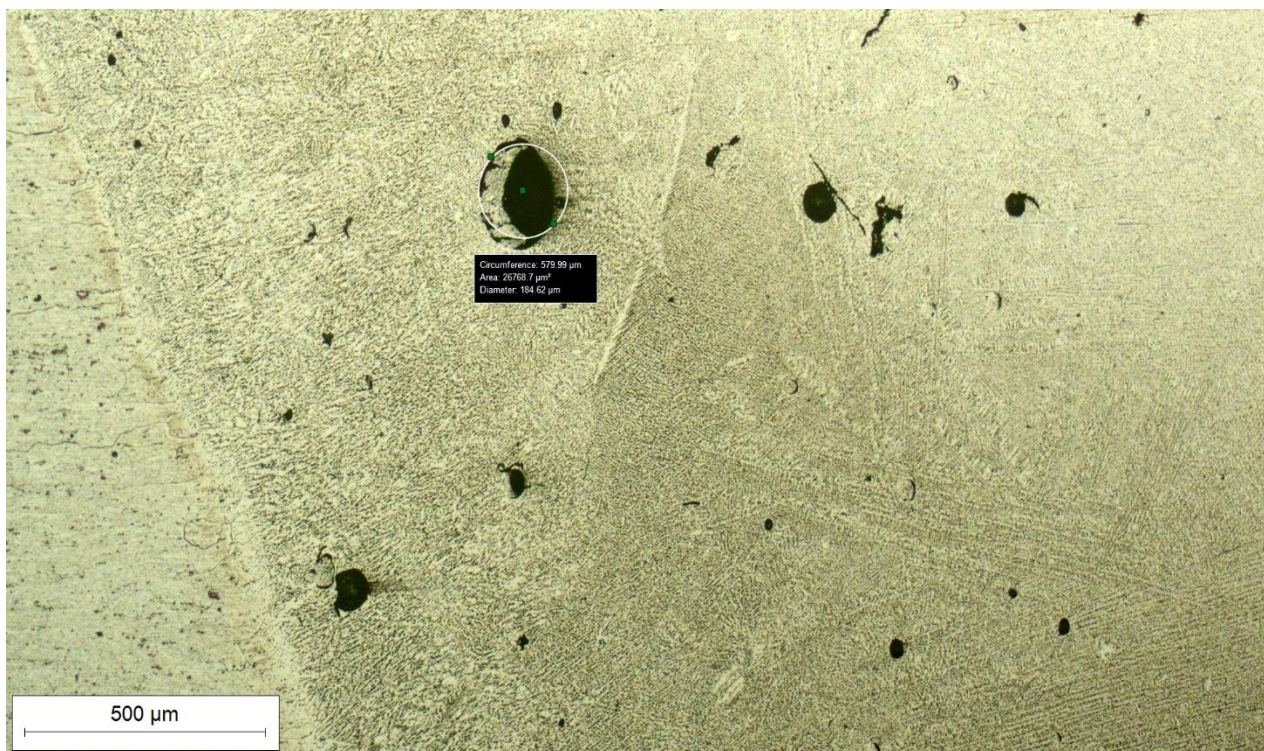
Slika 28 Uzorak AC, ZUT, sredina, 50x (a)
