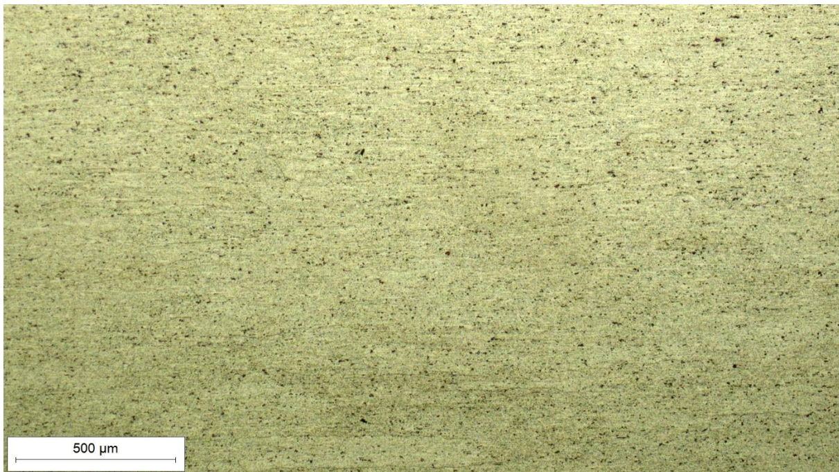
Slika 25 Osnovi materijal EN AW 6082 nakon žarenja, 50x
