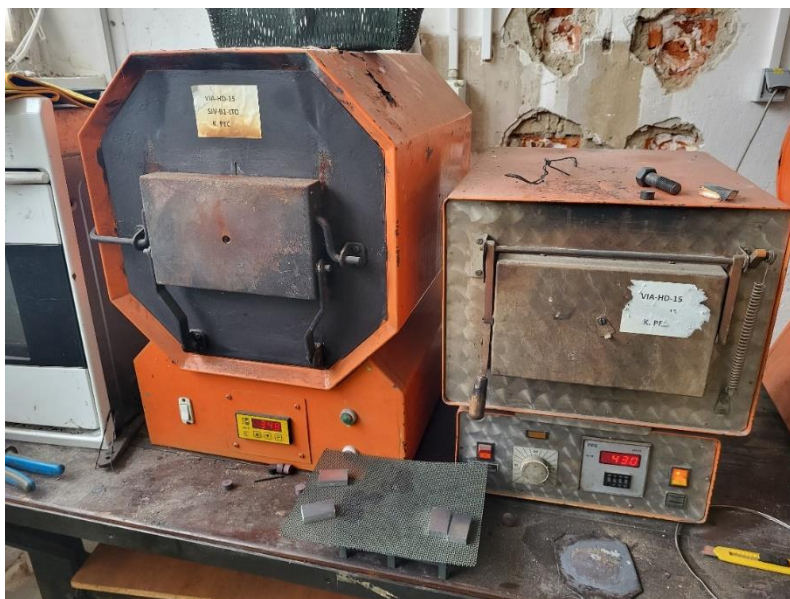
Slika 18 Žarenje uzoraka u pećima
