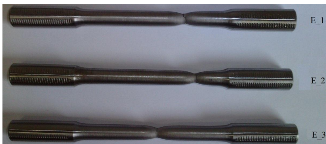
Slika 60. Epruvete nakon ispitivanja
