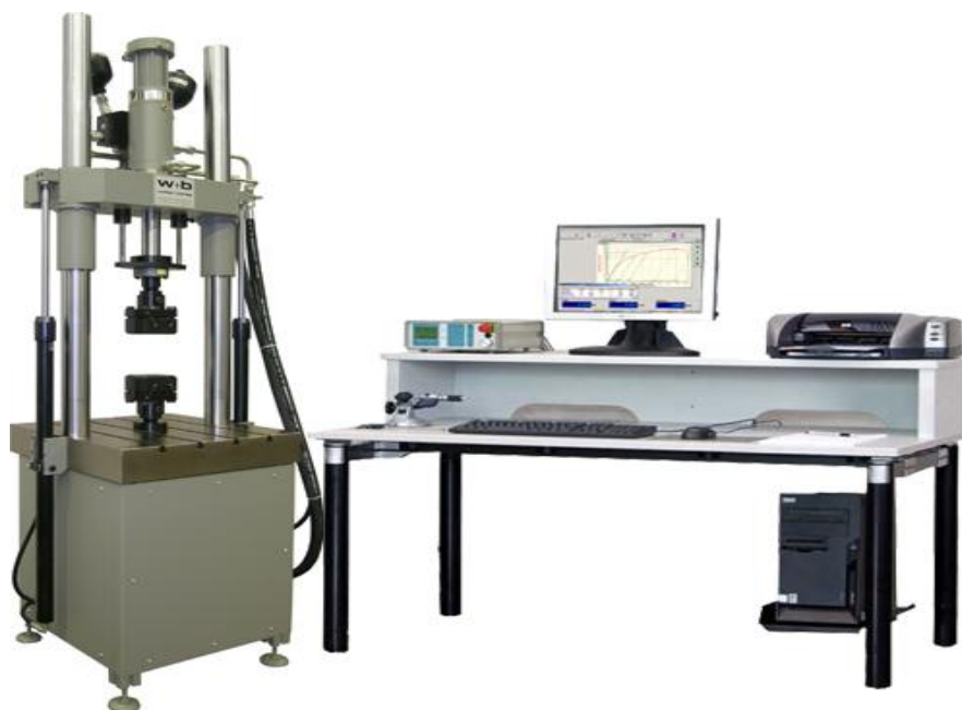
Slika 62. Servohidraulička umaralica LFV 50-HH s upravljačkom jedinicom
