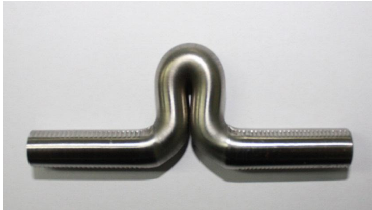
Slika 65. Epruveta opterećena velikom tlačnom silom
