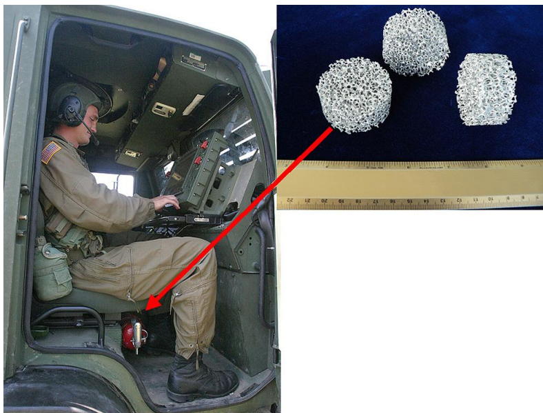
Slika 33 – Duocel aluminijska pjena promjera 5 cm u FMTV vozilu za zaštitu posade pri udaru [13]
