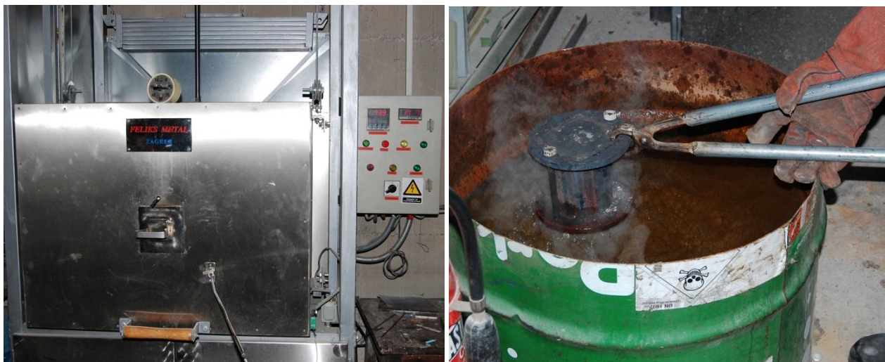
Slika 53 – Elektrootporna peć i hlađenje kalupa uranjanjem u vodu
