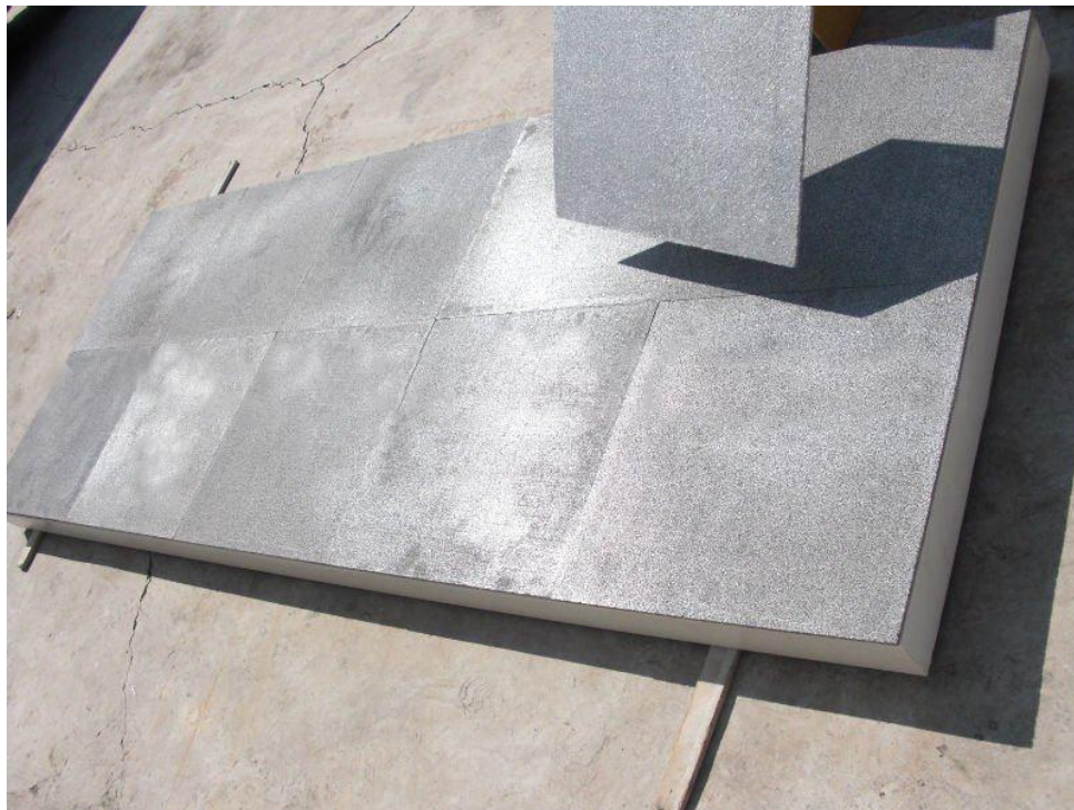
Slika 49 – Vatrootporne ploče aluminijske pjene za toplinsku izolaciju [16]
