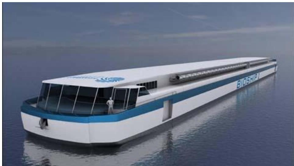
Slika 39 – Model broda Bioship1 sa dnom i oplatom trupa zamjenjenima aluminijskom pjenom te tako smanjenom težinom 30% [14]
