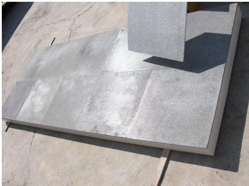
Slika 49 – Vatrootporne ploče aluminijiske pjene za toplinsku izolaciju [16]
