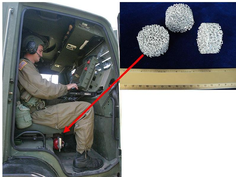
Slika 33 – Duocel aluminijска pjena promjera 5 cm u FMTV vozilu za zaštitu posade pri udaru [13]
