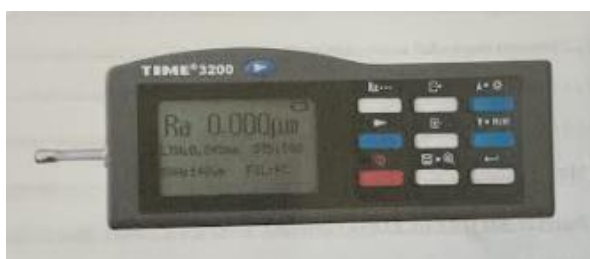
Slika 24. Prijenosni uređaj za mjerenje hrapavosti TR 3202
