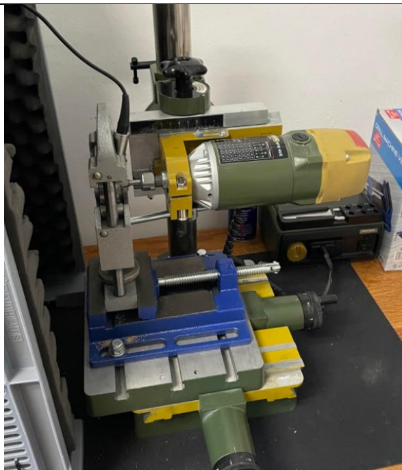
Slika 43. Bušilica Proxxonn za pogon ležaja zadanim brzinama vrtnje
