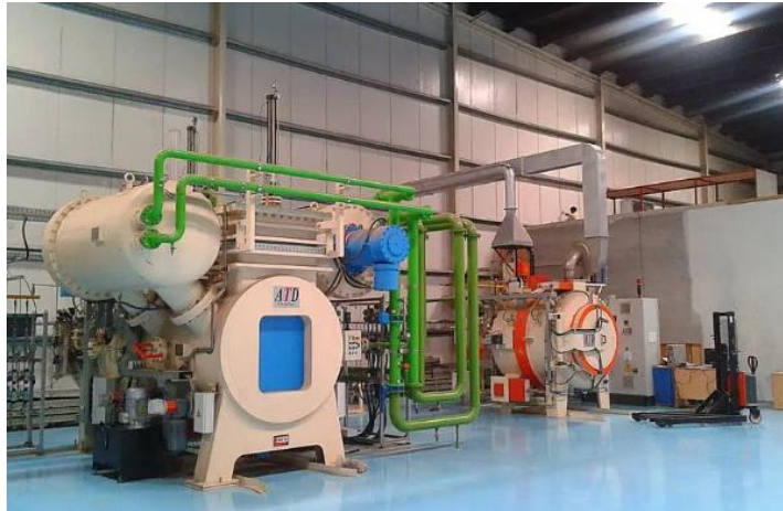
Slika 10. Postrojenje za nitiranje u plinu [10]
