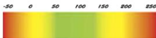
Slika 18. Područje optimalne radne temperature ležaja [18]
