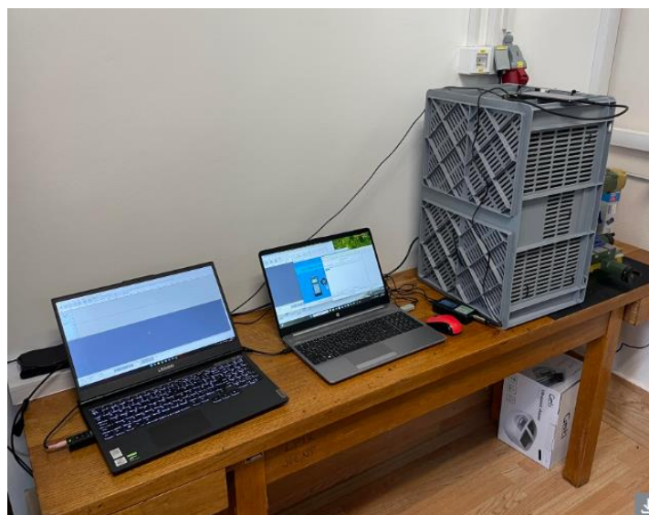
Slika 47. Postav za snimanje buke i vibracija igličastog ležaja
