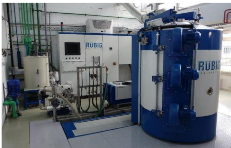
Slika 20. Peć za nitriranje u plazmi Rubig PN 70/90
