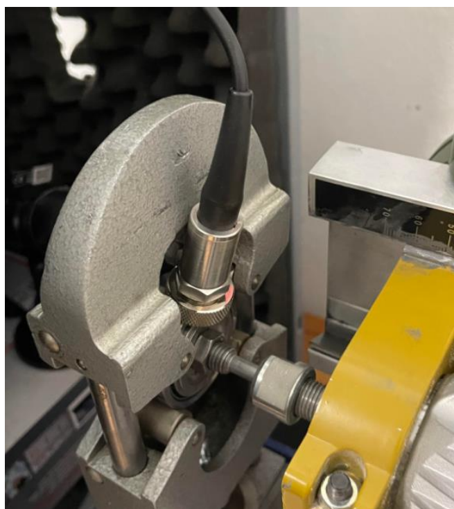
Slika 42. Sonda za mjerenje vibracija spojena na vanjski prsten ležaja
