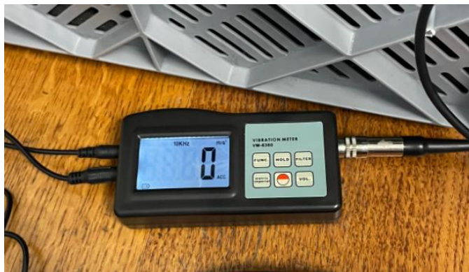
Slika 41. Mjerač vibracija VM-6360
