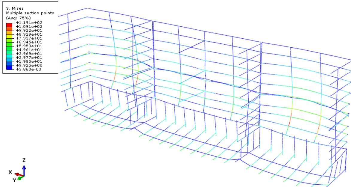
Slika 38. Raspodjela naprezanja na grednim elementima
