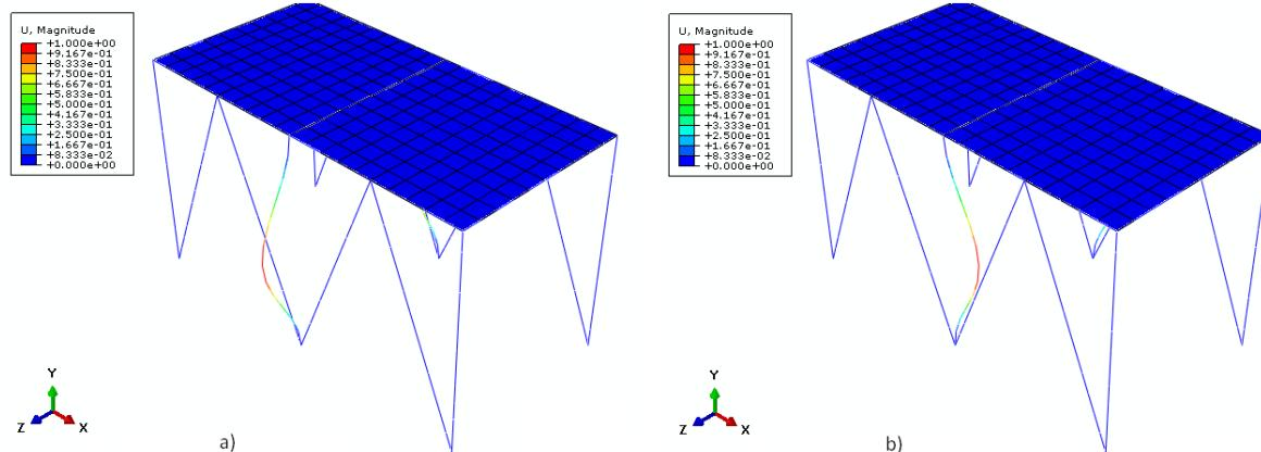
**Slika 132. Prikaz gubitka stabilnosti konstrukcije (treća i četvrta vlastita vrijednost)**
