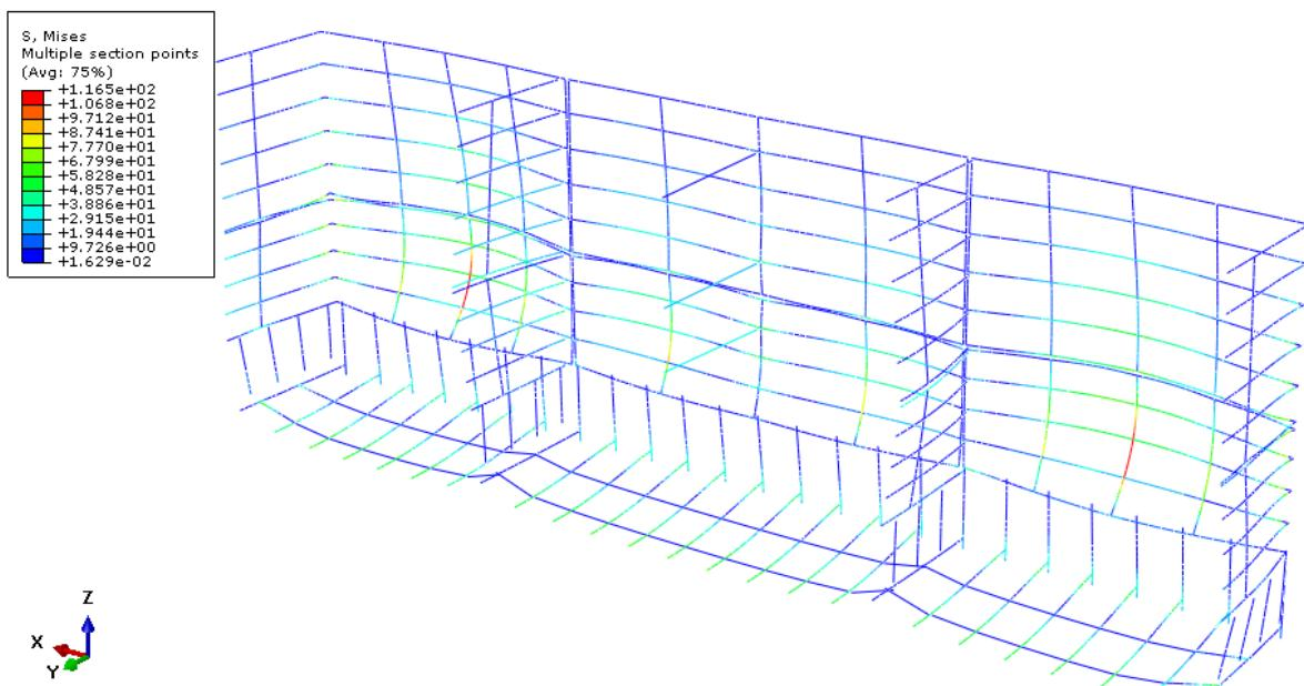
Slika 74. Raspodjela naprezanja na grednim elementima
