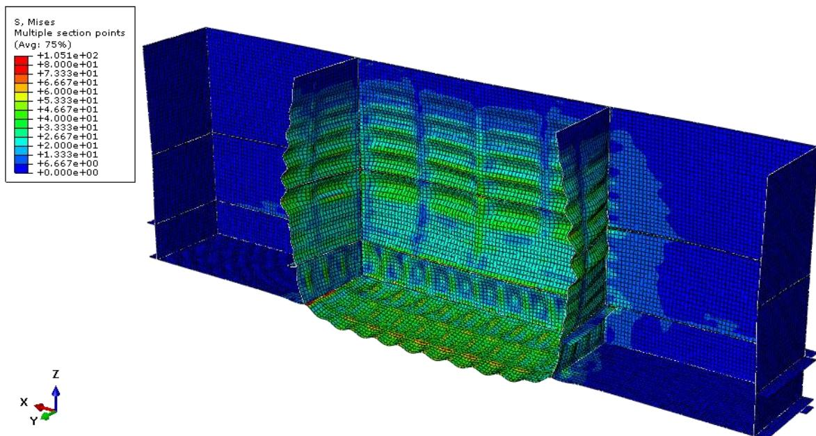
**Slika 63. Raspodjela naprezanja na pločama**
