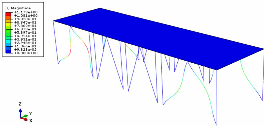
Slika 150. Oblik gubitka stabilnosti (četvrta vlastita vrijednost)
