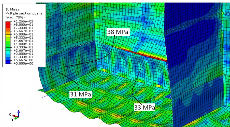
Slika 155. Raspodjela naprezanja na prednjim i bočnim pločama
