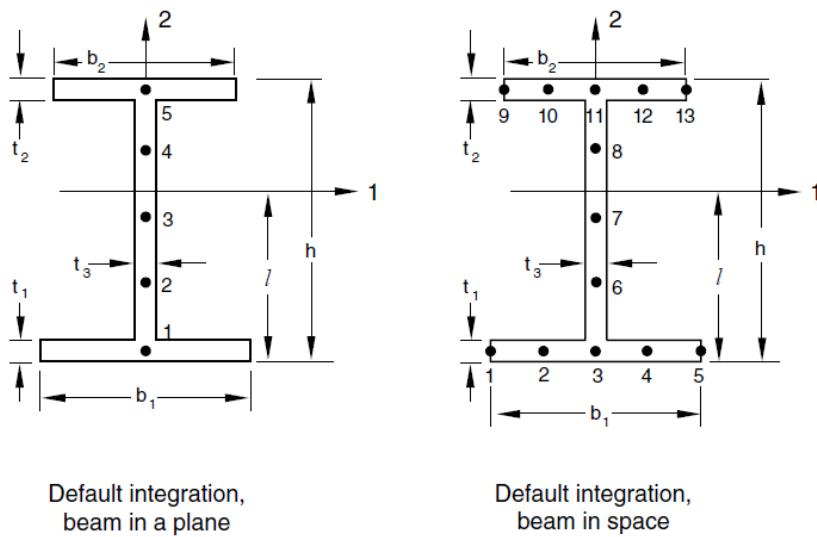
**Slika 6. Poprečni presjek I-profilja [3]**
