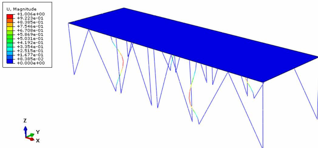
Slika 145. Oblik gubitka stabilnosti (četvrta vlastita vrijednost)
