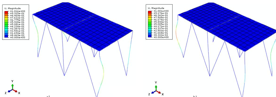
**Slika 134. Prikaz gubitka stabilnosti konstrukcije (sedma i osma vlastita vrijednost)**
