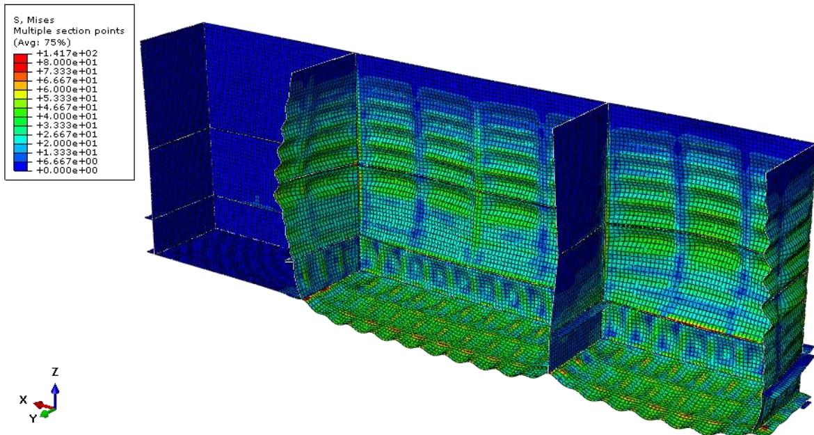
Slika 49. Raspodjela naprezanja na pločama
