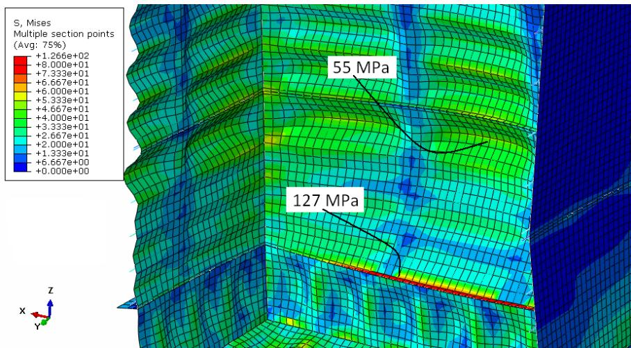
Slika 160. Raspodjela naprezanja na ploči B dijela koša
