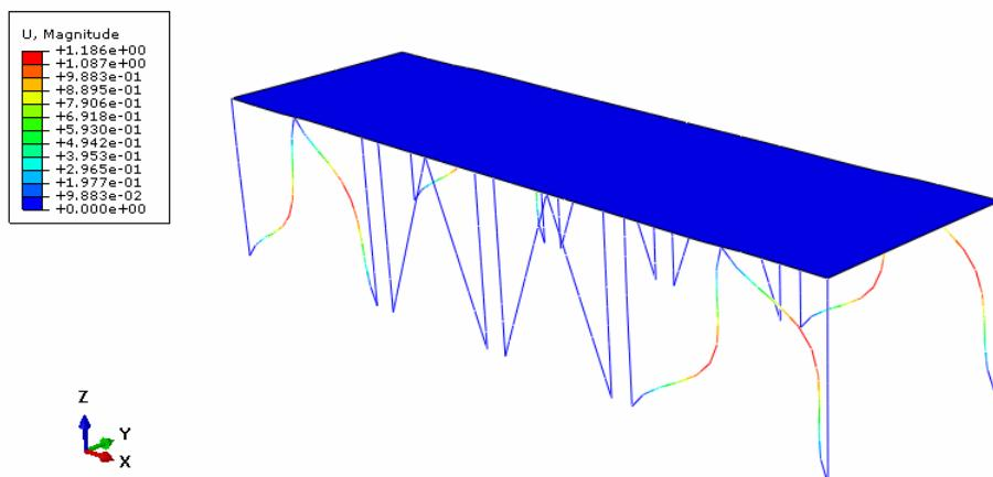
Slika 140. Oblik gubitka stabilnosti (četvrta vlastita vrijednost)
