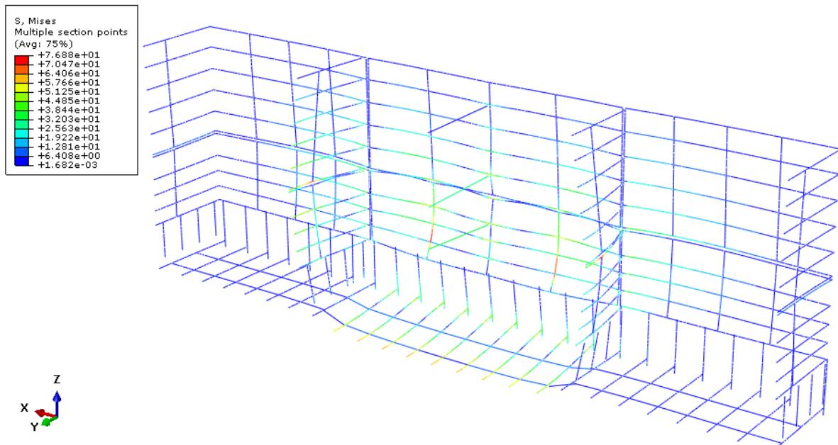
**Slika 64. Raspodjela naprezanja na grednim elementima**
