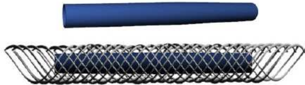
Slika 2.1. Struktura umjetnog mišića [3]
