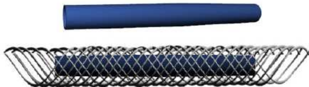
Slika 2.1. Struktura umjetnog mišića [3]
