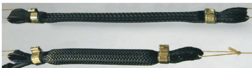
Slika 2.4. McKibbenov pneumatski mišić. Opušten (gore) i napuhan (dolje) [5]
