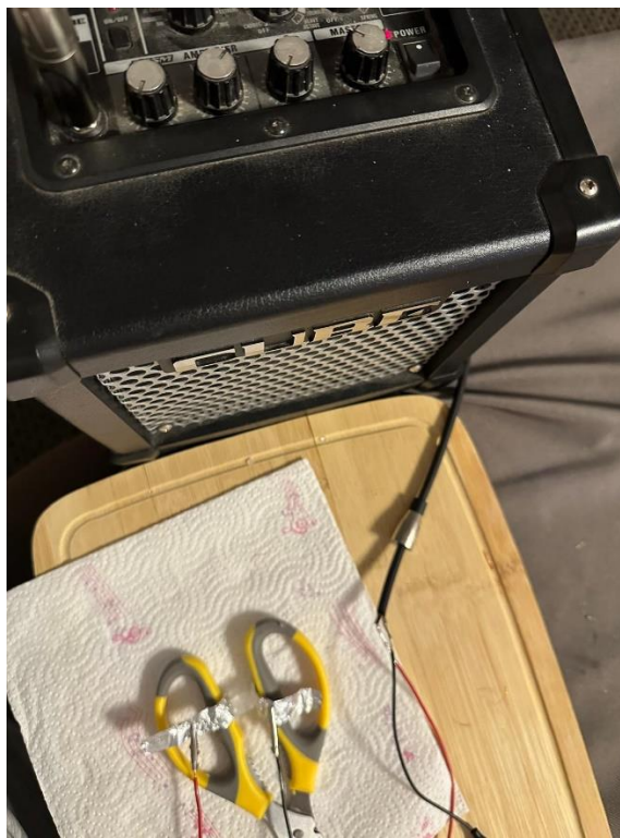
Slika 41. Izvedba kontaktnog mikrofona
