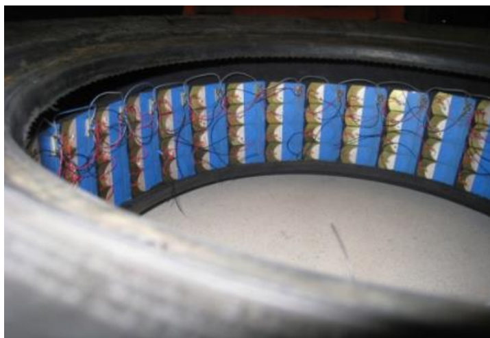
Slika 18. Niz PZT elemenata na unutrašnjosti gume [48]
