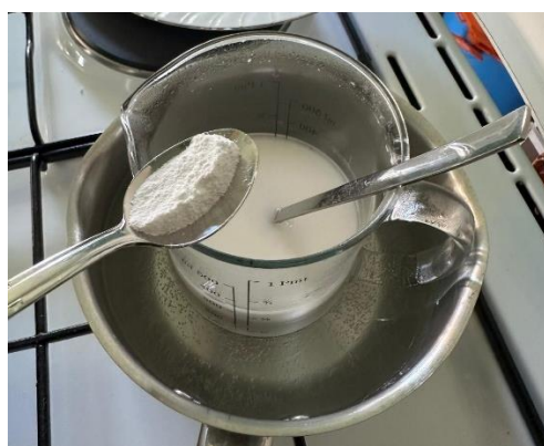
Slika 29. Dodavanje pet grama natrijevog karbonata u prethodnu otopinu
