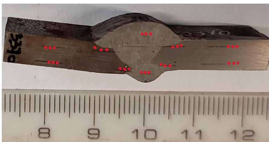
Slika 58. Područja na kojima je mjerena tvrdoća HV10
