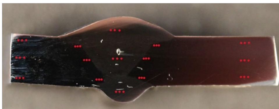
Slika 53. Područja na kojima je mjerena mikrotvrdoća HV 0,2
