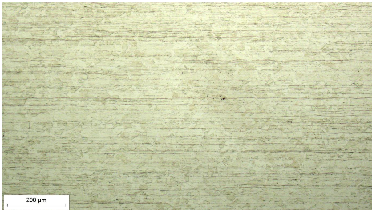
Slika 27. Mikrostruktura osnovnog materijala austenitnog nehrđajućeg čelika oznake X2CrNiMo17-12-2, snimljena pri povećanju od 100×
