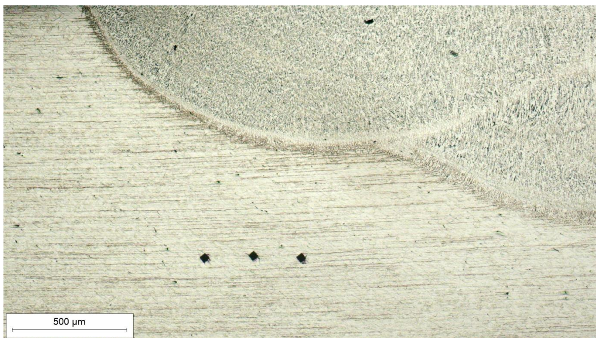
Slika 35. Mikrostruktura ZUT-a u tjemenu zavara sa strane austenitnog nehrđajućeg čelika oznake X2CrNiMo17-12-2, snimljena pri povećanju od 50 \times
