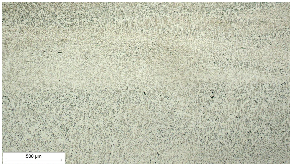
Slika 43. Mikrostruktura metala zavara u tjemenu, snimljena pri povećanju od 50×
