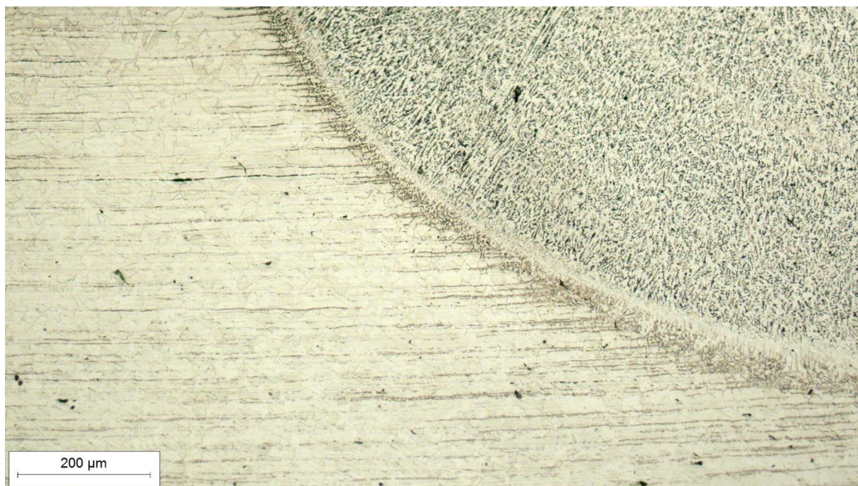
Slika 36. Mikrostruktura ZUT-a u tjemenu zavara sa strane austenitnog nehrđajućeg čelika oznake X2CrNiMo17-12-2, snimljena pri povećanju od 100×
