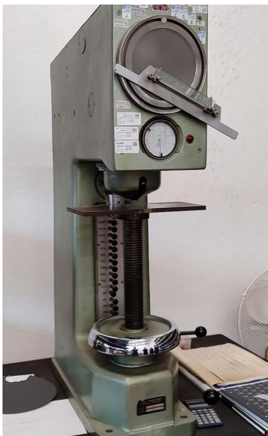
Slika 57. Karl Frank GmbH uređaj za mjerenje tvrdoće
