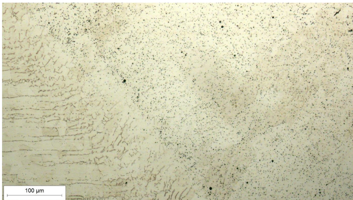
Slika 40. Mikrostruktura ZUT-a u sredini zavora sa strane austenitnog nehrđajućeg čelika oznake X2CrNiMo17-12-2, snimljena pri povećanju od 200×
