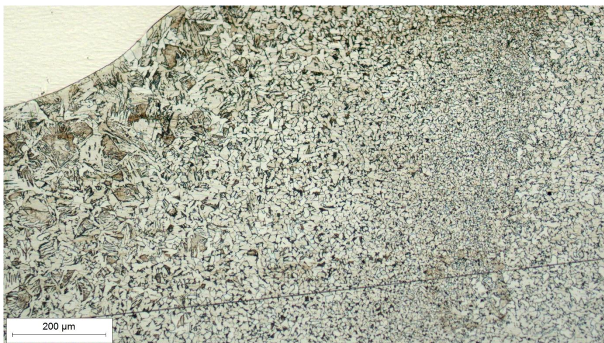
Slika 30. Mikrostruktura ZUT-a u tjemenu zavara, sa strane općeg konstrukcijskog čelika oznake S275JR, snimljena pri povećanju od 100×
