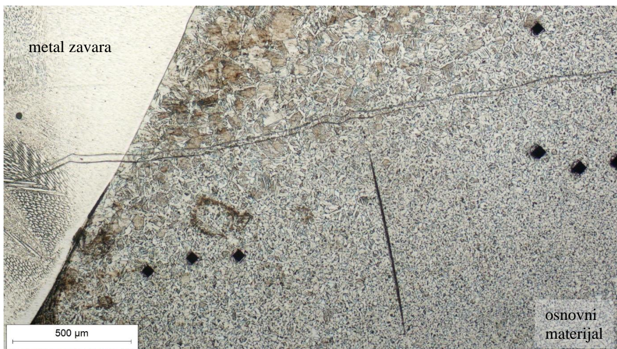
Slika 32. Mikrostruktura ZUT-a u sredini zavora, sa strane općeg konstrukcijskog čelika oznake S275JR, snimljena pri povećanju od 50×
