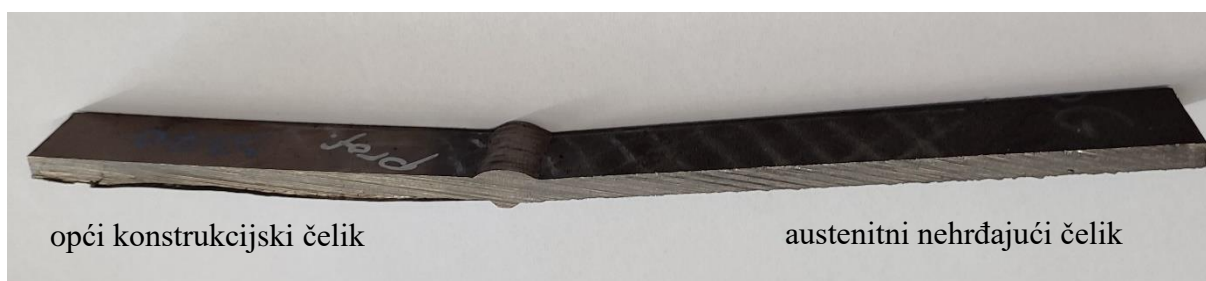
Slika 8. Zavareni spoj čelika S275JR i čelika X2CrNiMo17-12-2
