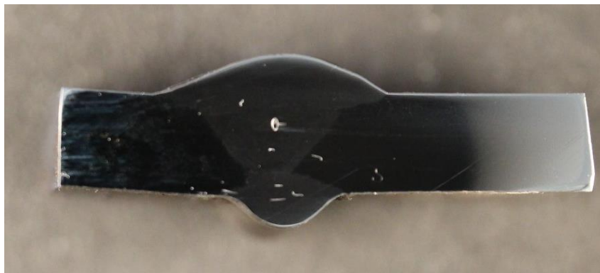
Slika 22. Uzorak nakon postupka nagrizanja u svrhu analize mikrostrukture
