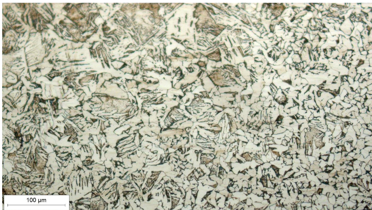
Slika 31. Mikrostruktura ZUT-a u tjemenu zavora, sa strane općeg konstrukcijskog čelika oznake S275JR, snimljena pri povećanju od 200×
