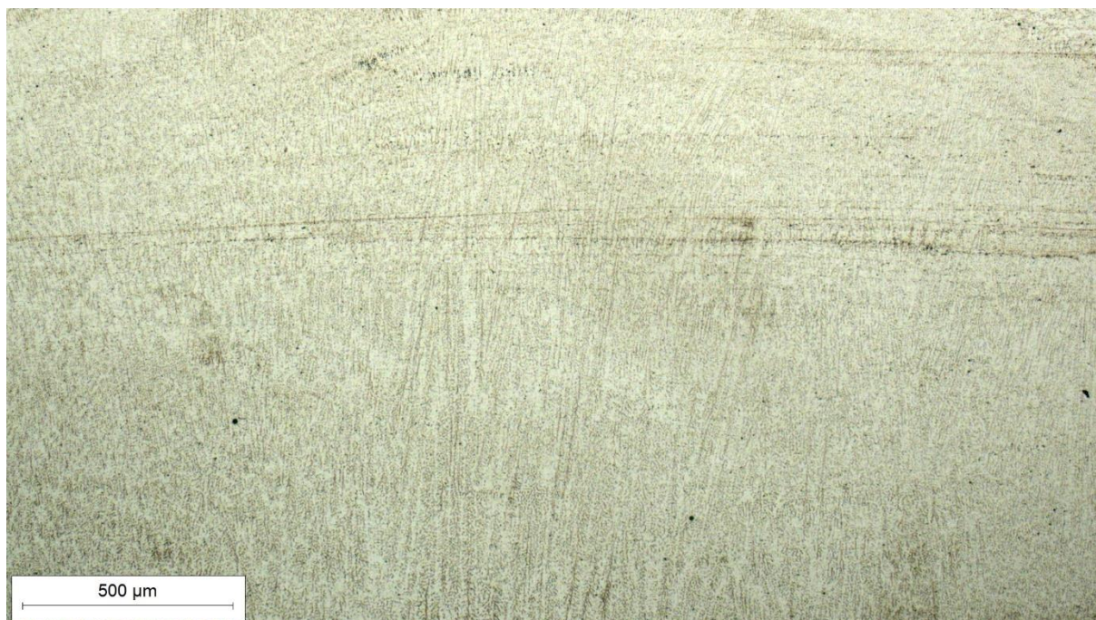
Slika 49. Mikrostruktura metala zavara u korijenu, snimljena pri povećanju od 50×
