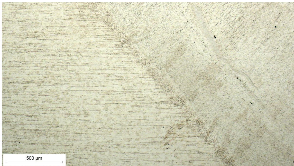
Slika 38. Mikrostruktura ZUT-a u sredini zavara sa strane austenitnog nehrđajućeg čelika oznake X2CrNiMo17-12-2, snimljena pri povećanju od 50×
