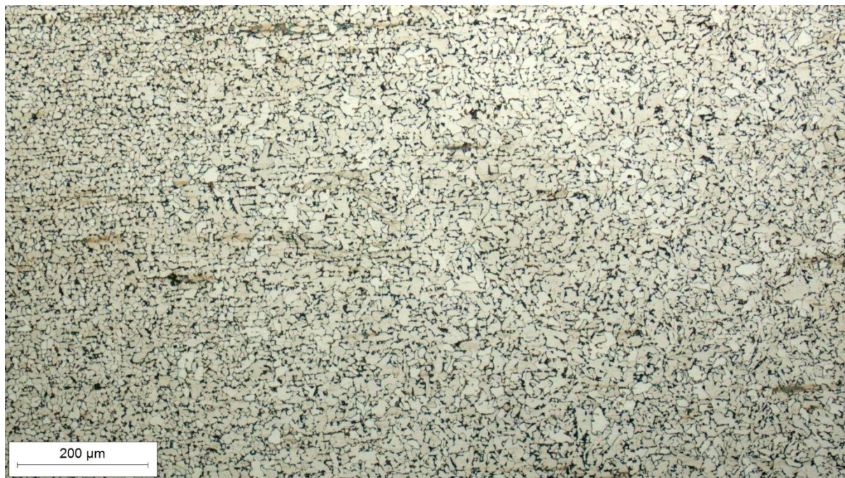
Slika 25. Mikrostruktura osnovnog materijala općeg konstrukcijskog čelika oznake S275JR, snimljena pri povećanju od 100 \times
