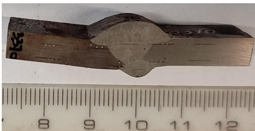
Slika 23. Makrostruktura zavarenog spoja
