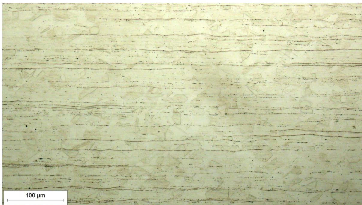
Slika 28. Mikrostruktura osnovnog materijala austenitnog nehrdajućeg čelika oznake X2CrNiMo17-12-2, snimljena pri povećanju od 200×
