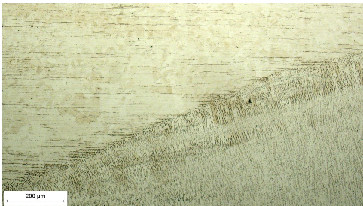
Slika 41. Mikrostruktura ZUT-a u korijenu zavora sa strane austenitnog nehrđajućeg čelika oznake X2CrNiMo17-12-2, snimljena pri povećanju od 100×
