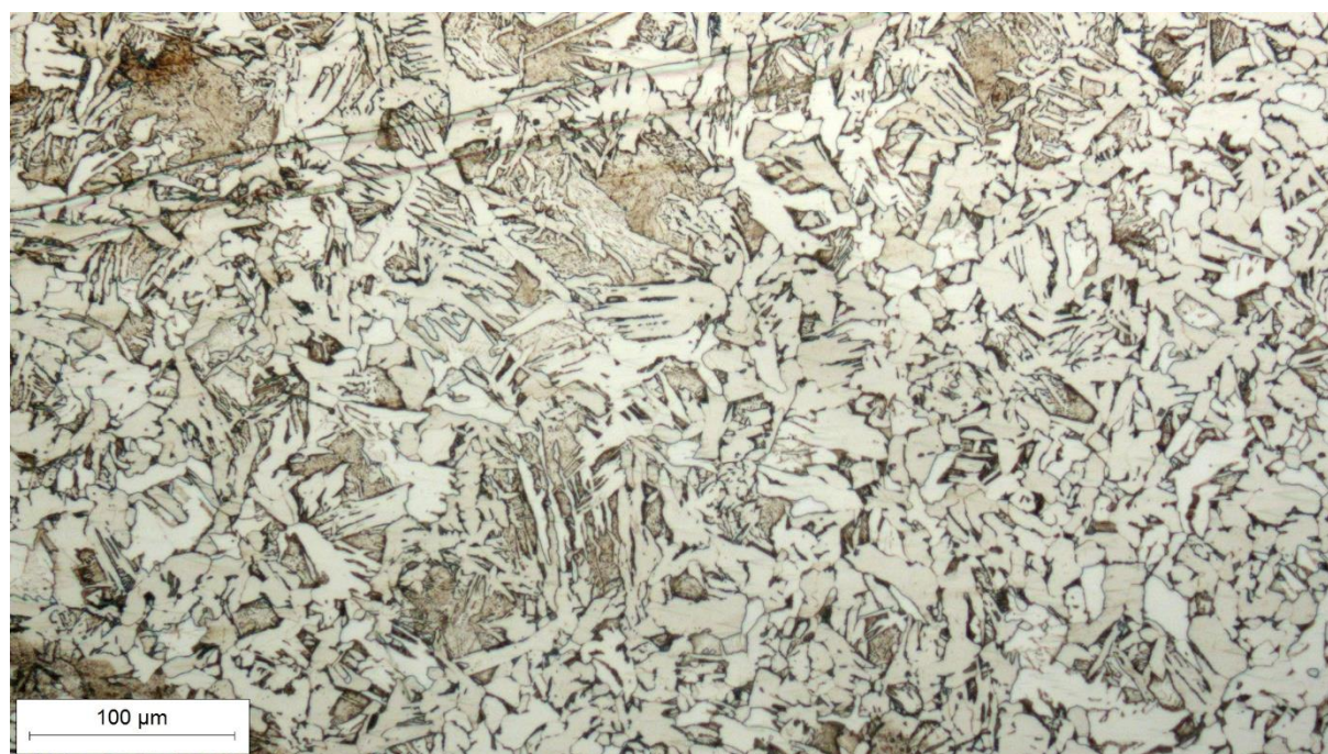
Slika 34. Mikrostruktura ZUT-a u sredini zavara, sa strane općeg konstrukcijskog čelika oznake S275JR, snimljena pri povećanju od 200×
