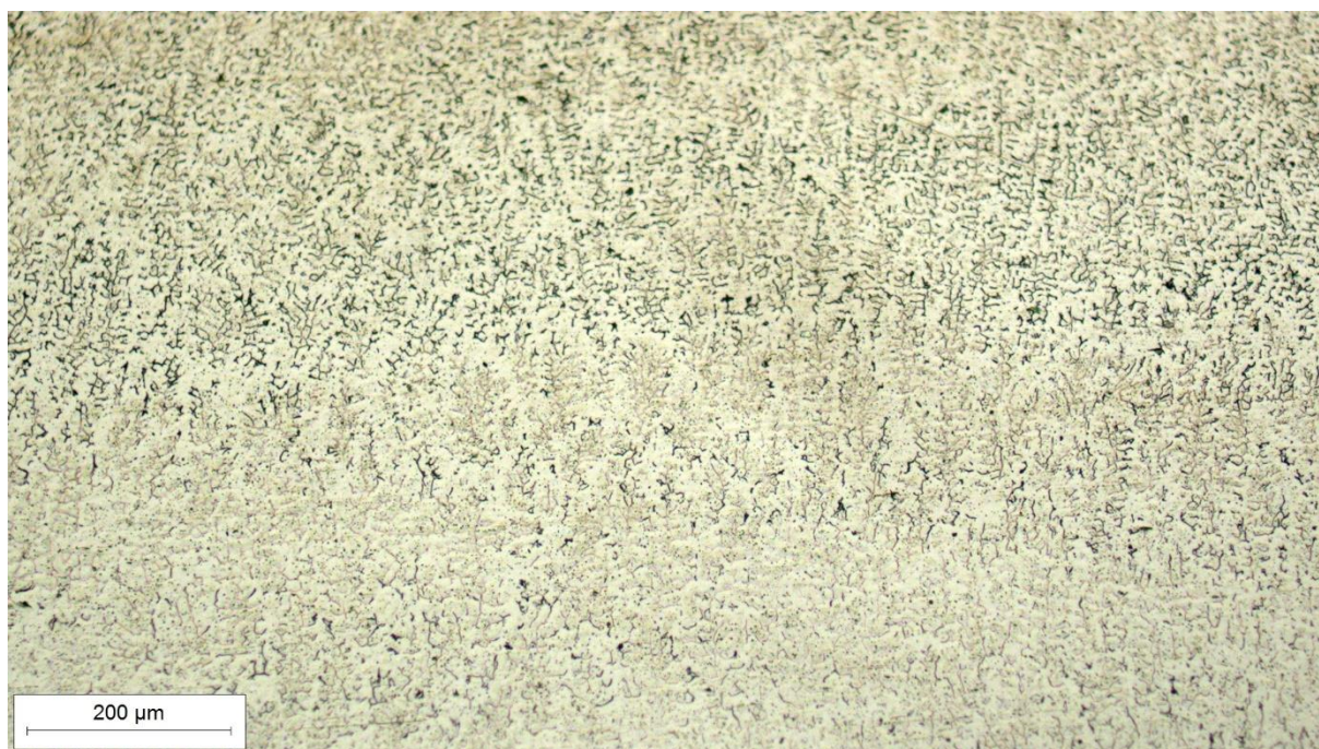
Slika 44. Mikrostruktura metala zavara u tjemenu, snimljena pri povećanju od 100×
