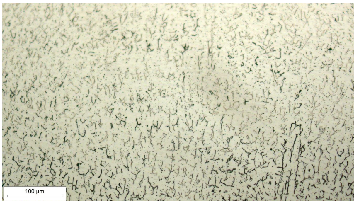
Slika 48. Mikrostruktura metala zavara u sredini, snimljena pri povećanju od 200×
