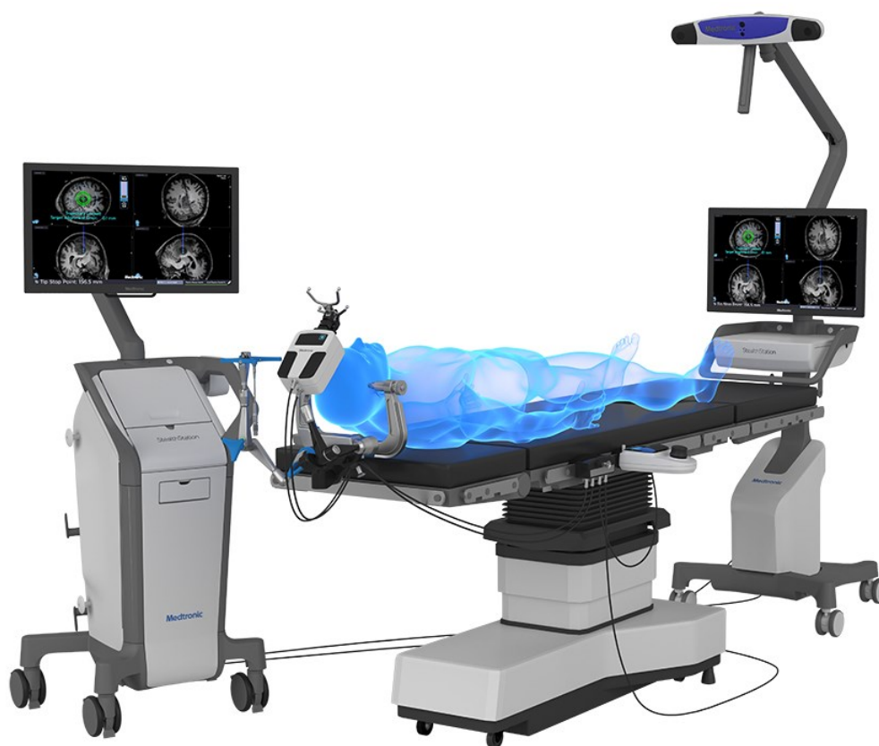
Slika 2. StealthStation neuronavigacijski sustav[4]
