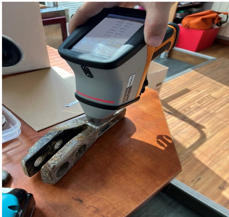
Slika 29. Tijek ispitivanja uzorka 1 XRF metodom
