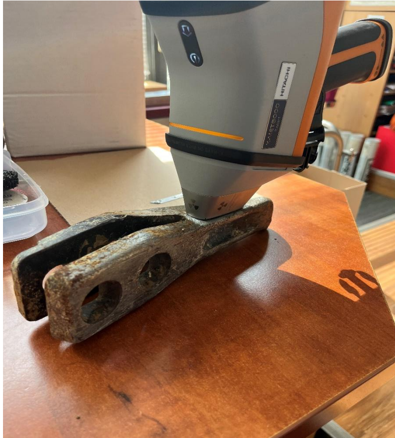
Slika 28. Tijek ispitivanja uzorka 1 XRF metodom
