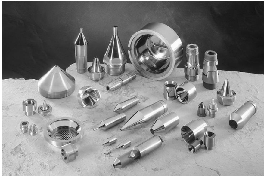
Slika 26. Borirani alati za ekstrudiranje [16]
