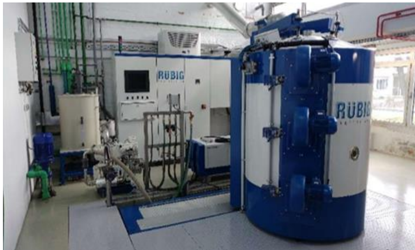
Slika 16. Vakuumska peć za nitriranje u plazmi
