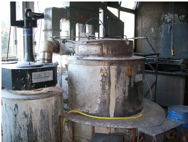
Slika 12. Spremnik za nitrokarburiranje u kupki TENIFER
