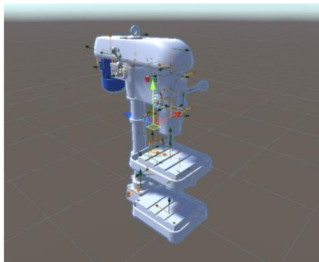
Slika 37. Nakon primjene svih ograničenja i spojeva iz CSV datoteke, na dijelovima sklopa moguće je vidjeti zglobove generirane skriptom
