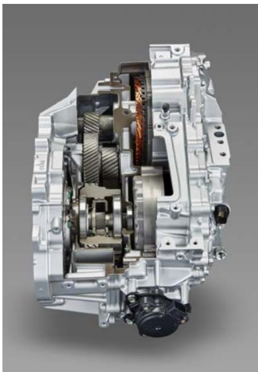
Slika 7 Elektronički kontrolirani varijabilni prijenos (e-CVT)
