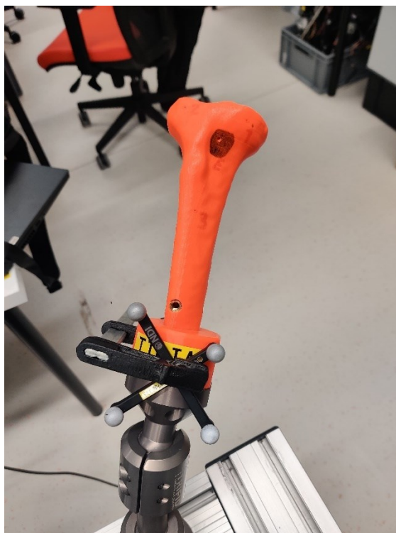
Slika 38. 3D printana kost tibije sa statičnim markerom
