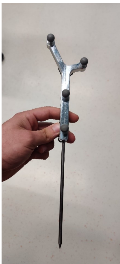
Slika 17. Ručno vođeni alat s pasivnim markerima - stylus
