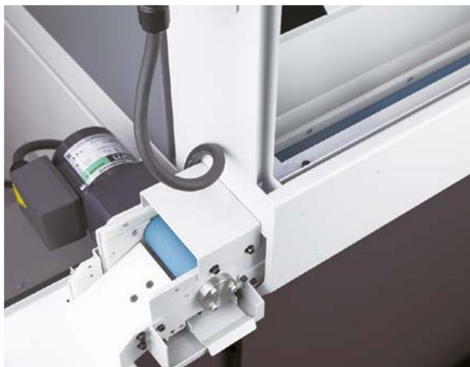
Slika 46. Konvejer za transport izradaka pogonjen elektromotorom [46]
