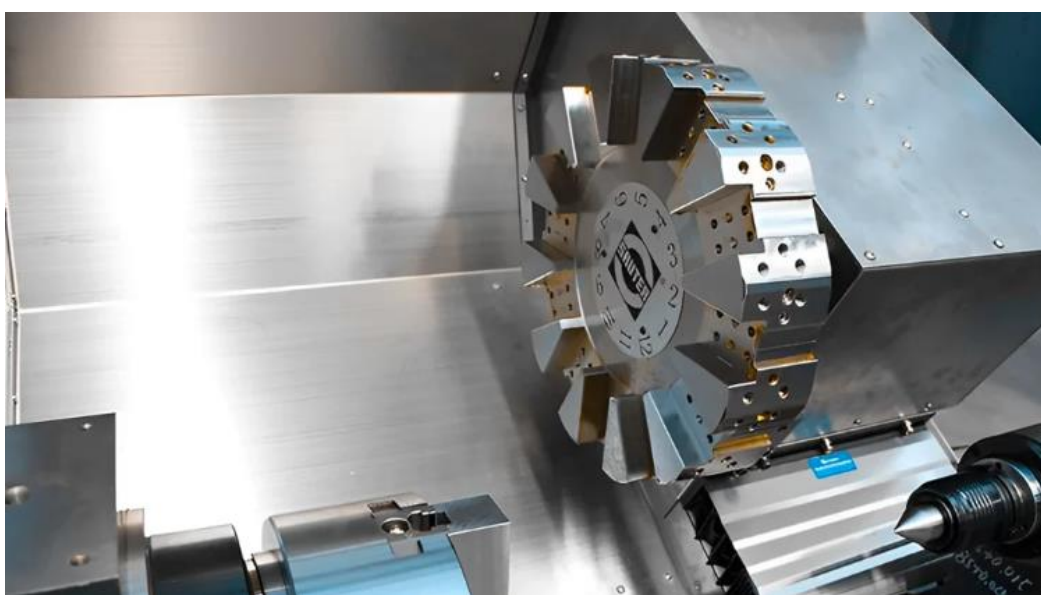
Slika 24. Revolverska glava bez postavljenih alata [28]
