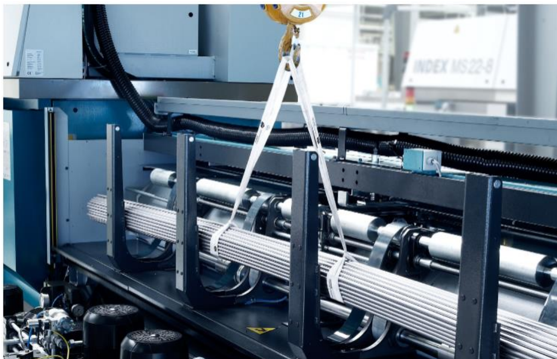
Slika 34. Spremnik za šipke u dodavaču [35]
