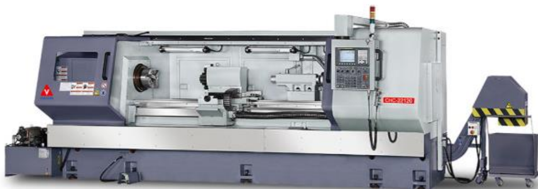
Slika 17. Numerički upravljana tokarilica Sun master CHC 22120 [23]
