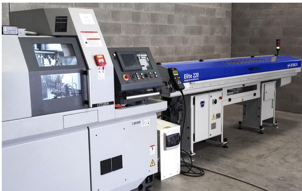
Slika 45. Swiss-type tokarilica s dodavačem šipke [47]
