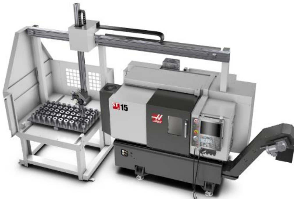
Slika 37. Tokarska obradna čelija proizvođača Haas [41]
