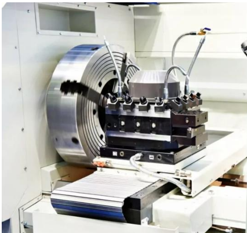
Slika 18. Nosač alata s funkcijom automatske izmjene alata i vidljivim cijevima za dovod SHIP-a [22]
