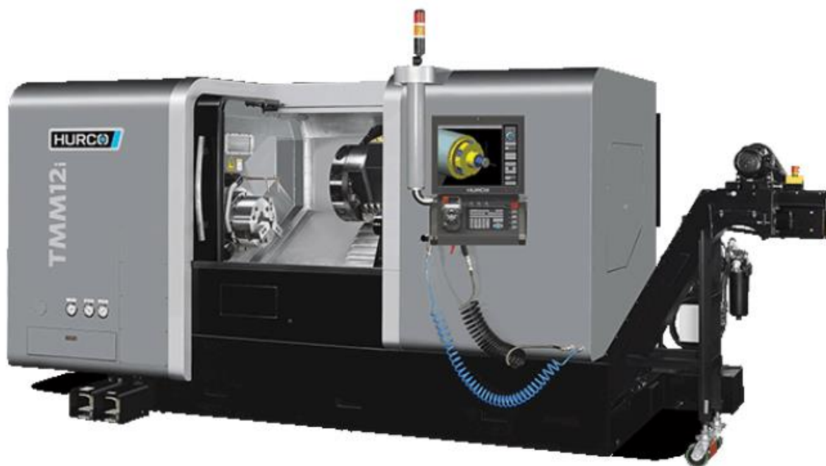
Slika 31. Tokarski obradni centar Hurco TMM12i [33]
