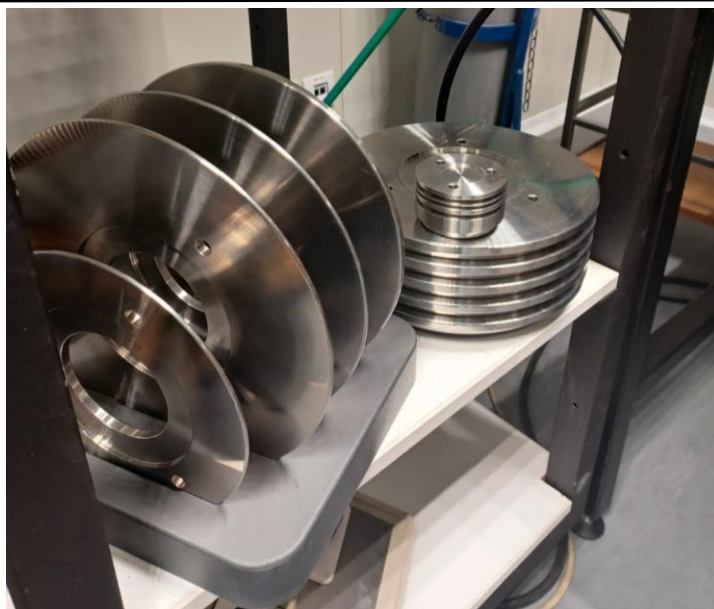
Slika 15. Utezi koji dolaze uz tlačnu vagu
