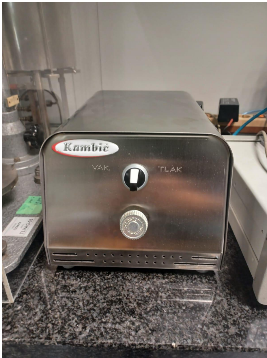
Slika 7. Vakuumsko tlačna pumpa
