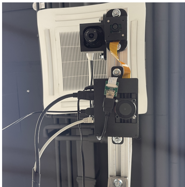
Slika 3.8: Montaža kamera i Jetson Nano računala
