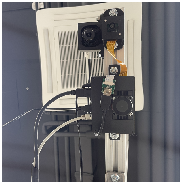
Slika 3.8: Montaža kamera i Jetson Nano računala
