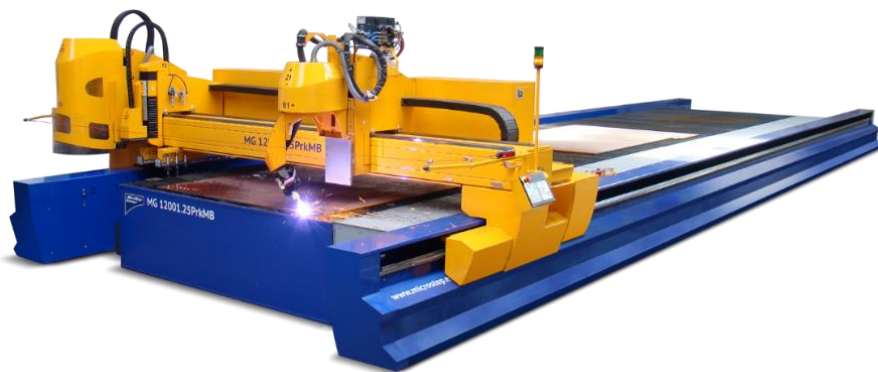
Slika 12. 5-osni stroj za plazma rezanje velikih pločastih materijala [25]
