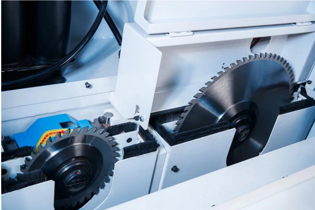
Slika 25. Listovi predrezača i pile za rezanje ugrađeni u pomičnoj glavi za rezanje [43]
