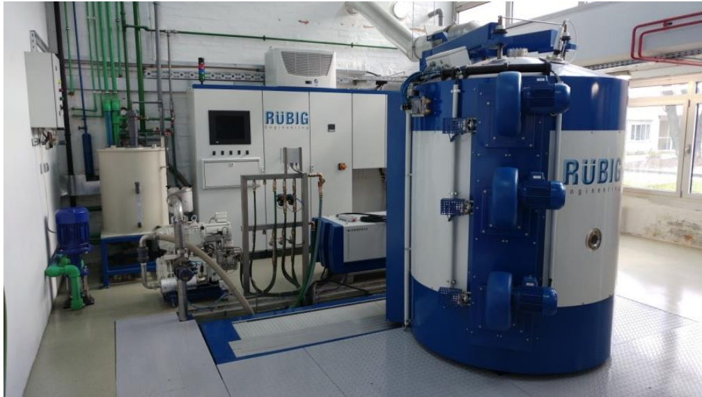
Slika 5. Prikaz vakumske peći PC 70/90 za prevlačenje PACVD postupkom
