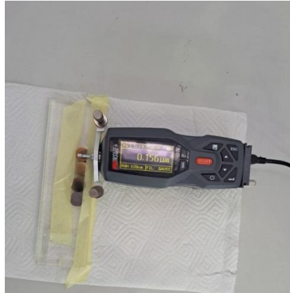
Slika 23. Prikaz uređaja za mjerenje hrapavosti površine InsizeISR-C002
