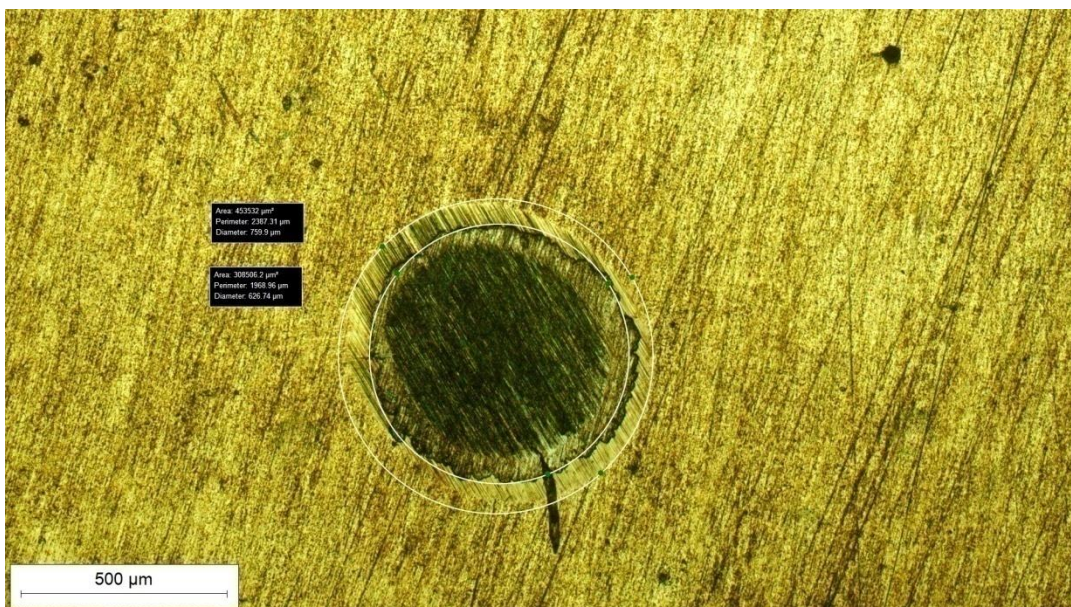
Slika 20. Dimenzije vanjskih i unutarnjih kružnica oko otiska nakon provedenog ispitivanja kalotesterom za uzorak C2
