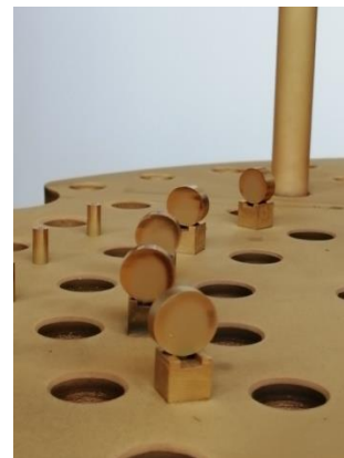
Slika 6. Prikaz uzoraka nakon prevlačenja prevlakom PACVD TiN
