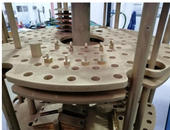
Slika 6. Prikaz uzoraka nakon prevlačenja prevlakom PACVD TiN
