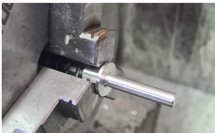
Slika 34. Desna osovinica na tokarskom stroju
