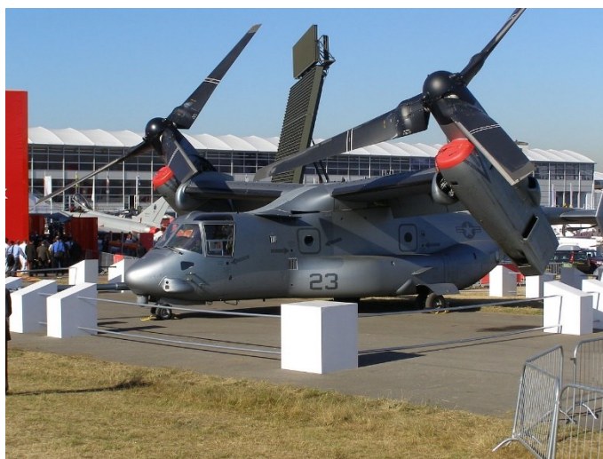
Slika 1.1 Vojni zrakoplov V-22 Osprey sa zakrivljenim rotorima, preuzeto s [1]
