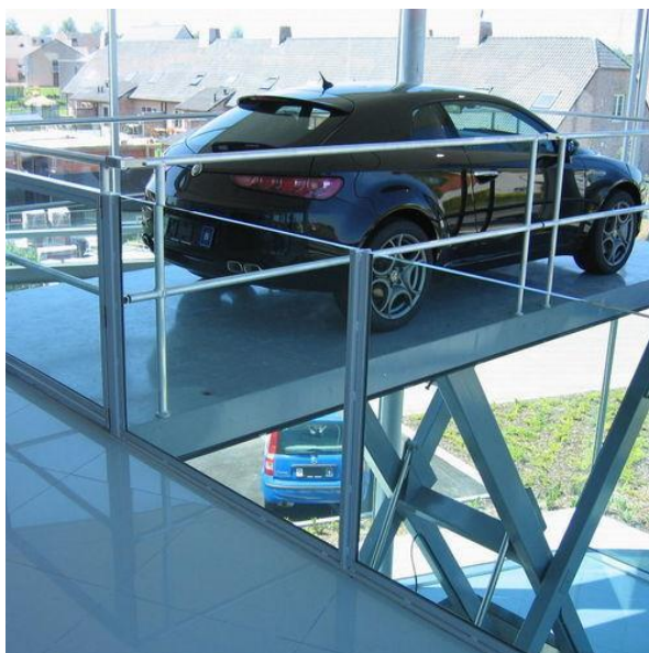
Slika 24. a) škarasta podizna platforma s velikim škarama za veći doseg podizanja za unutarnju uporabu; b) škarasta podizna platforma s većim brojem škara i velikim dosegom podizanja
