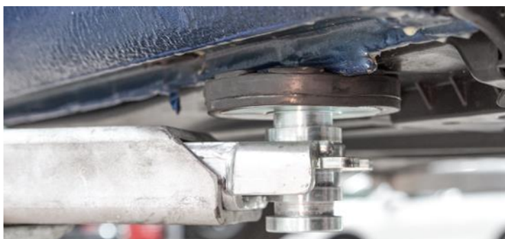
Slika 4. Gumeni nastavak za kontakt preko podvozja vozila
