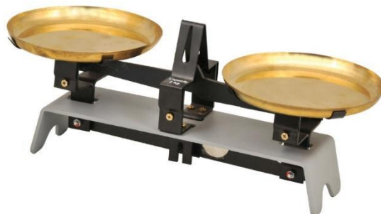
Slika 18. Komercijalna vaga na bazi Robervalovog principa
