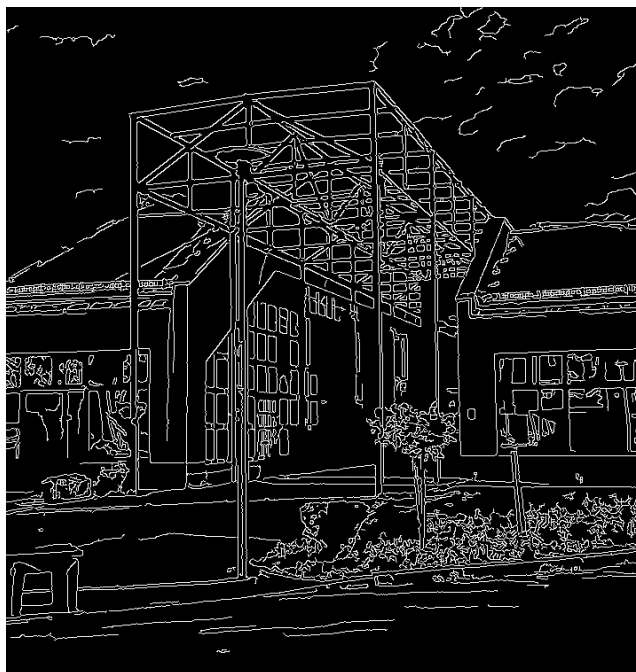
Slika 25. Magnituda gradijenta (Canny edge)
