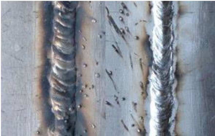
Slika 24. Krivi smjer zavarivanja (crni zavar) [21]
