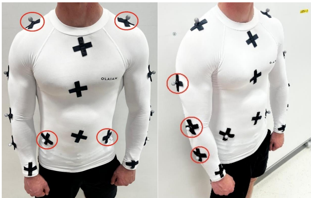
Slika 9. Raspored markera na trupu ispitanika (lijevo) Raspored markera po ruci ispitanika (desno)
