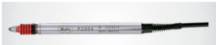
Slika 33 Induktivno ticalo Mahr P2004M [19]
