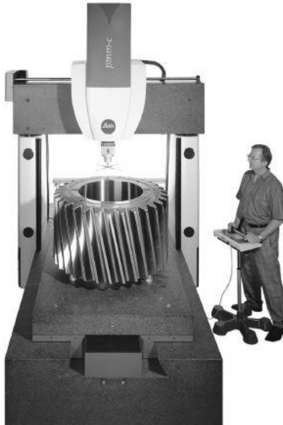
Slika 6. Primjer statične mostne strukture [4]
