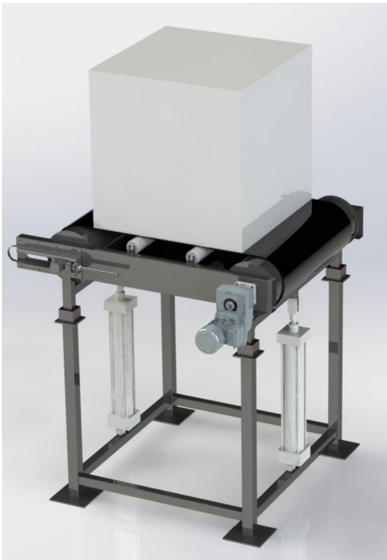
Slika 26. Izgled konstrukcije transportne trake
