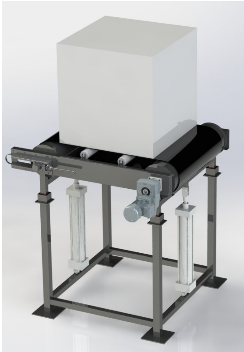
Slika 26. Izgled konstrukcije transportne trake
