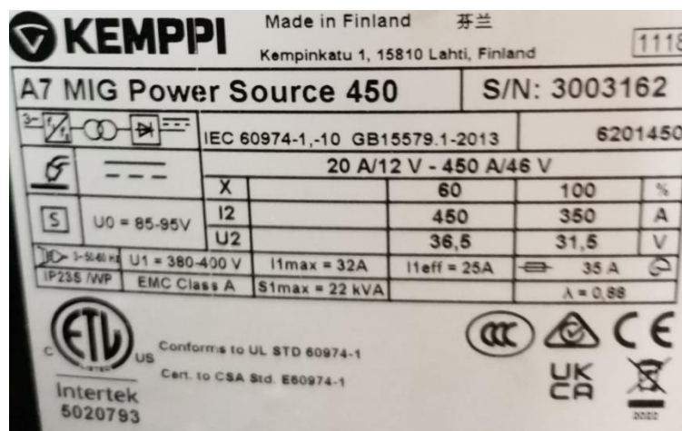
Slika 42. Specifikacijska pločica Kemppi A7 MIG 450
