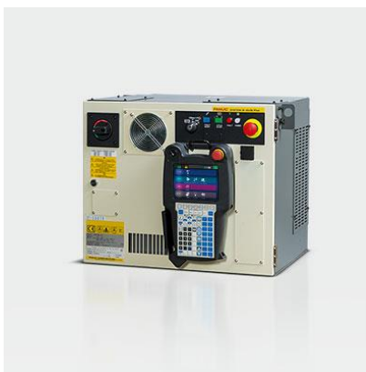
Slika 40. R-30iB upravljačka jedinica s privjeskom za učenje [32]
