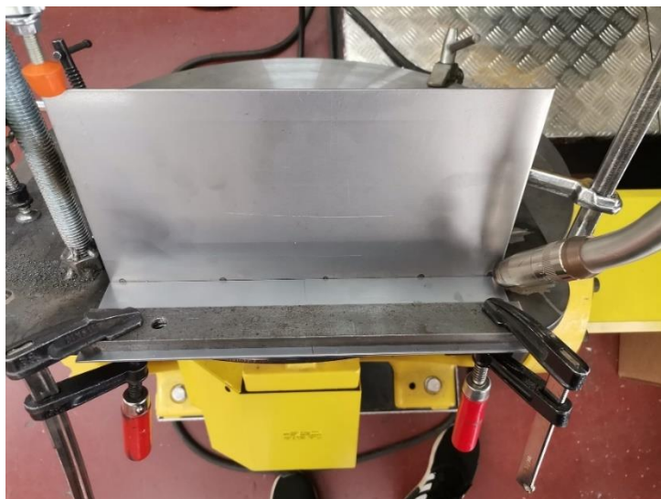
Slika 58. Položaj pištolja za zavarivanje – lijeva tehnika rada
