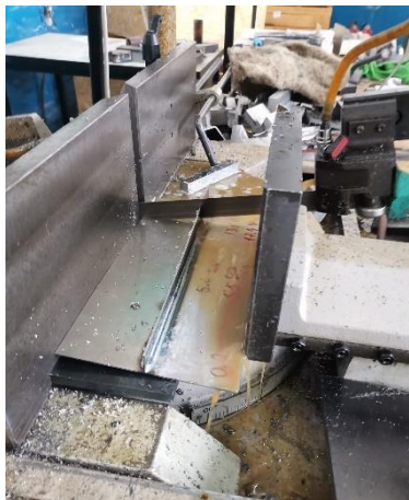
Slika 73. Rezanje makroizbrusaka na tračnoj pili
