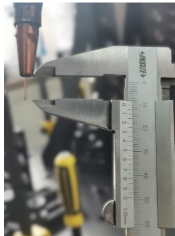
Slika 54. Mjerenje duljine slobodnog kraja žice
