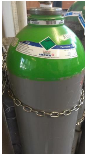
Slika 53. Spremnik zaštitnog plina Ferroline C18
