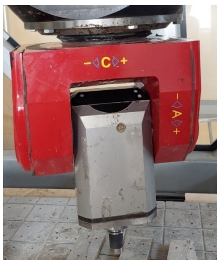
Slika 11. Rotacijske osi stroja
