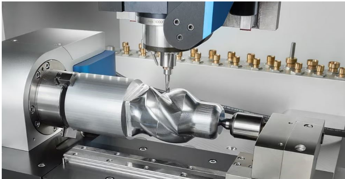
Slika 3. 4-osna CNC glodalica [5]
