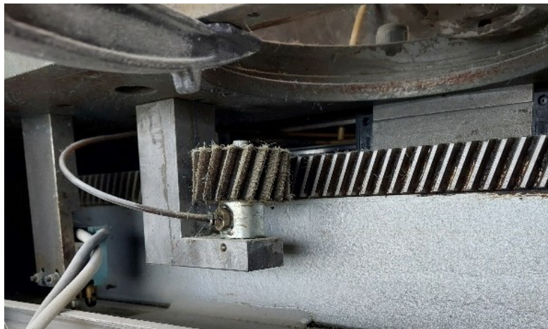
Slika 24. Spužvasti zupčanik za podmazivanje pogonskog zupčanika i zubne letve
