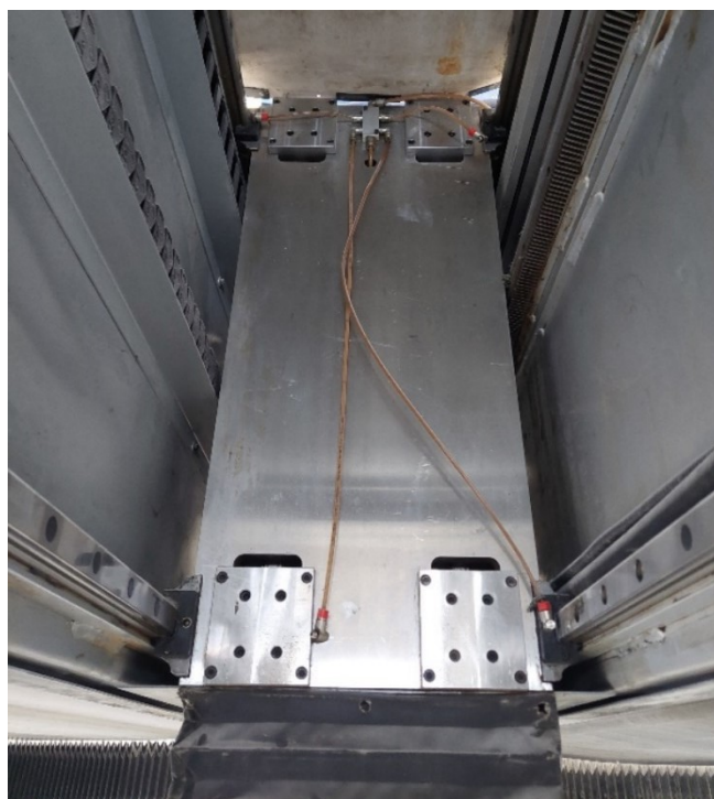
Slika 25. Podmazivanje klizača i linearnih vodilica
