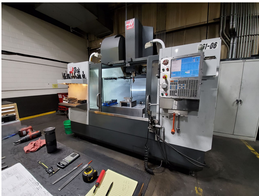
Slika 2. 3-osna CNC glodalica [4]
