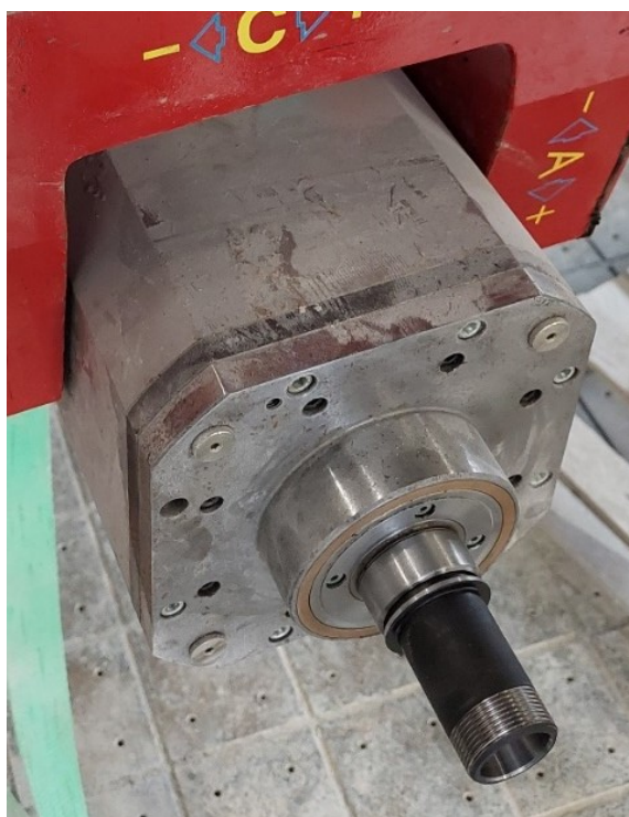
Slika 15. Motorvreteno obradnog centra
