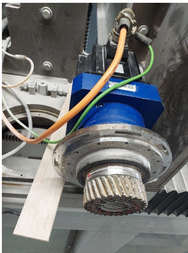
Slika 12. Pogonski PMSM motor, reduktor i zupčanik posmičnog prigona Y osi
