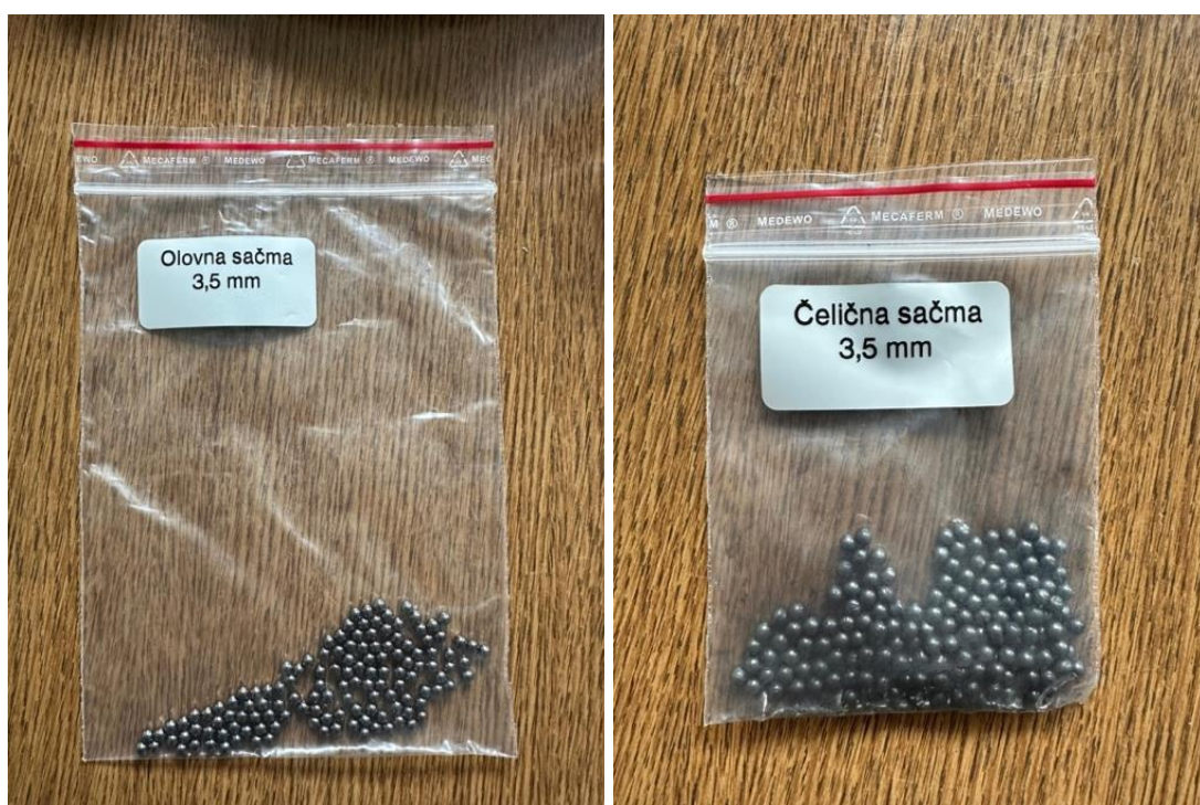
Slika 34. Prikaz olovne i čelične sačme korištene u eksperimentu
