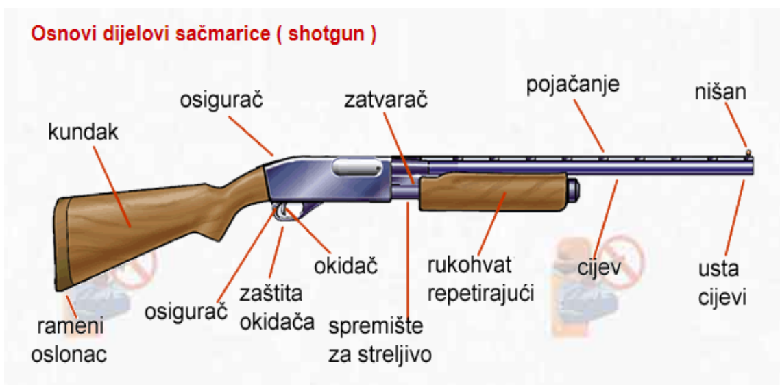
Slika 13. Prikaz osnovnih dijelova sačmarice [17]
