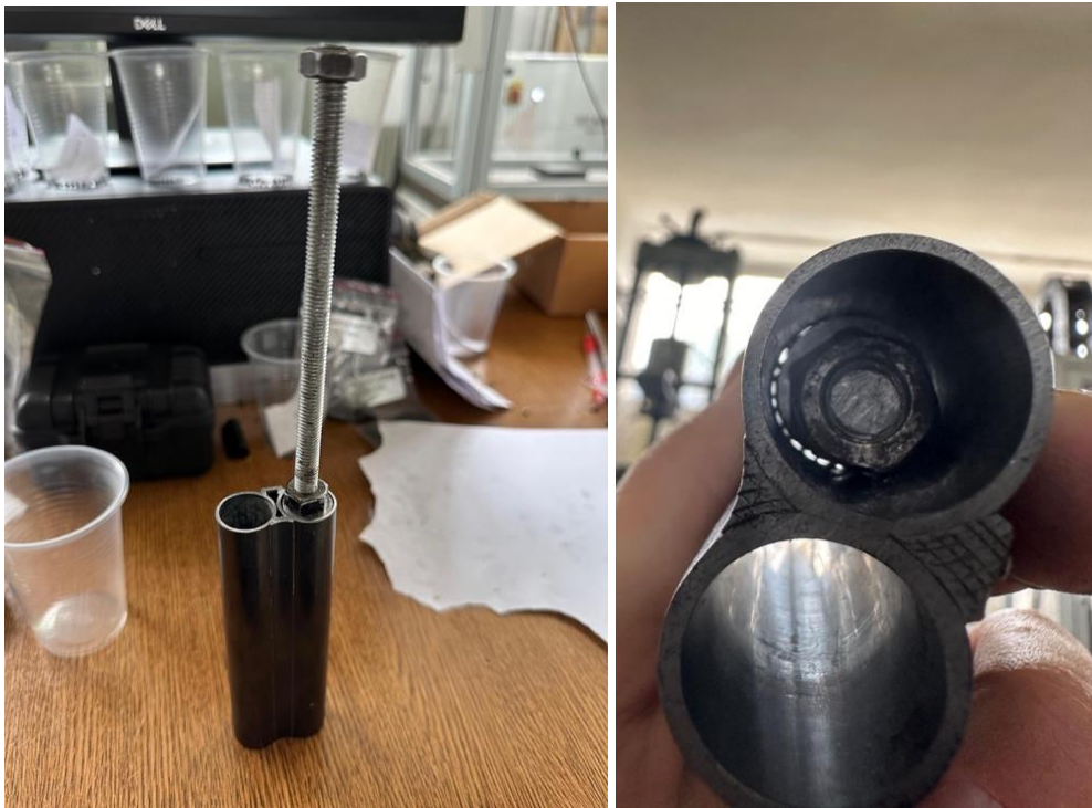
Slika 35. Prikaz ispitnog uzorka prije utiskivanja u cijev(lijevo) i nakon utiskivanja u cijev(desno)
