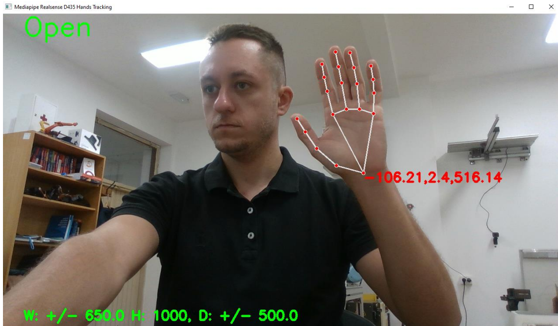
Slika 16. Prikaz korisničkog sučelja – prepoznata gesta Open (otvorena hvataljka) i koordinate u crvenoj boji koje znače da je koordinata van definiranog radnog prostora (slika autora)
