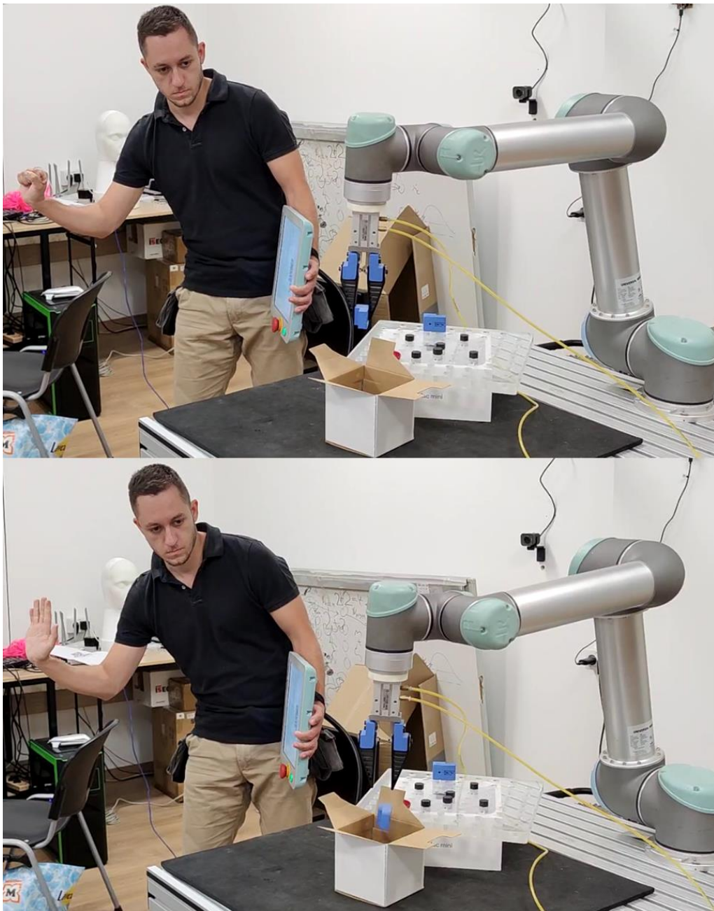
Slika 30. Testiranje kobota UR5 – pomicanje i ubacivanje predmeta u kutiju (slika autora)
