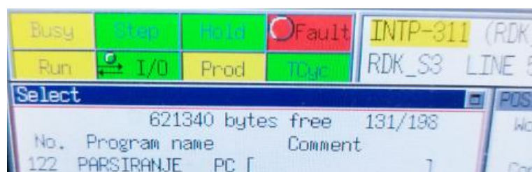
Slika 12. Privjesak za učenje ne javlja greške i robot je spreman za rad (slika autora)
