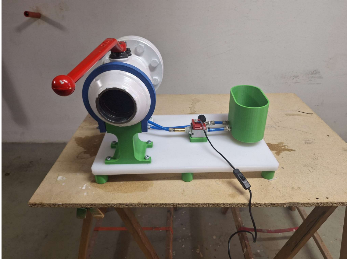
Slika 43. Montaža pumpe i spremnika vode
