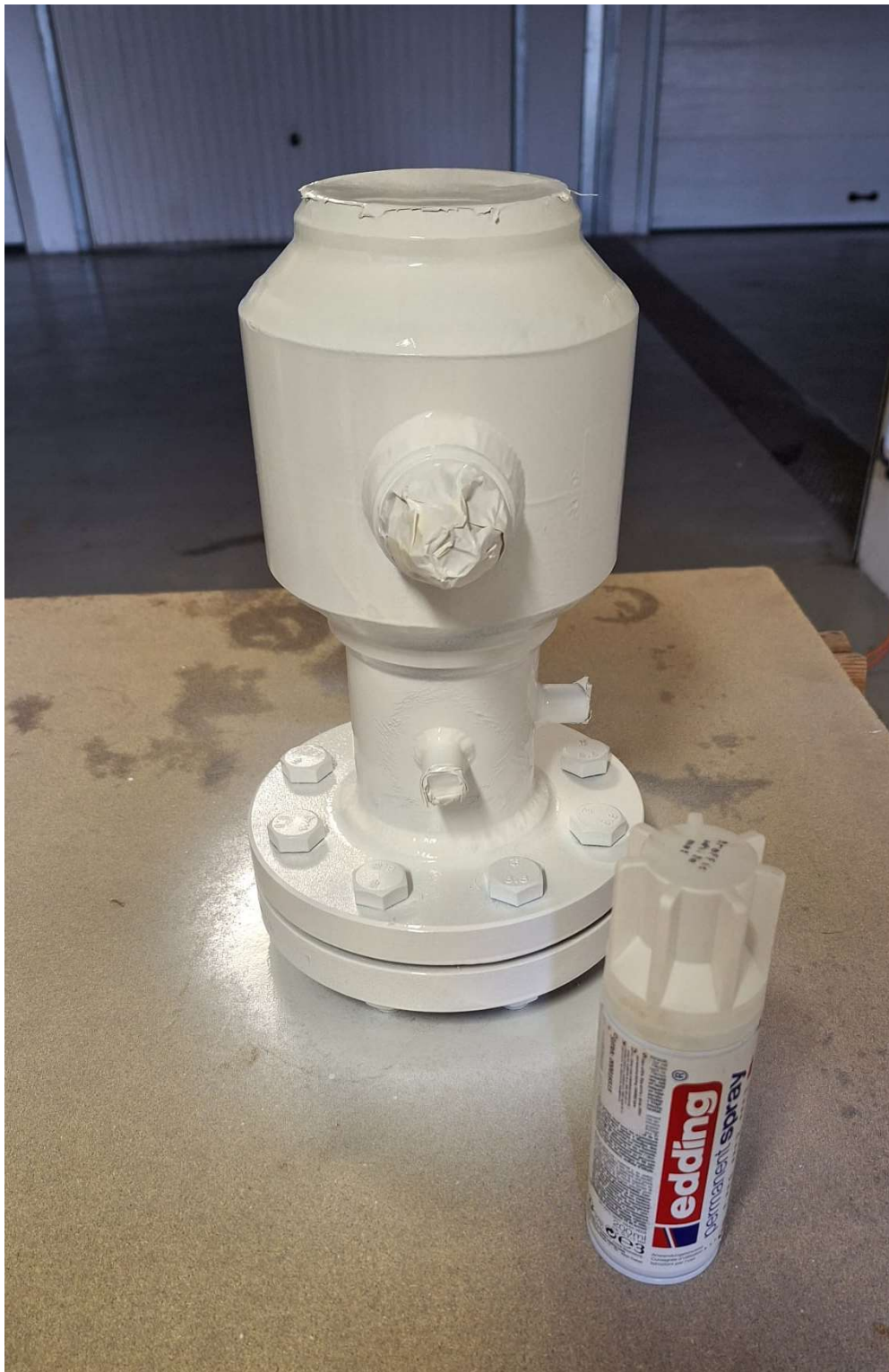
Slika 27. Komora nakon završnog premaza
