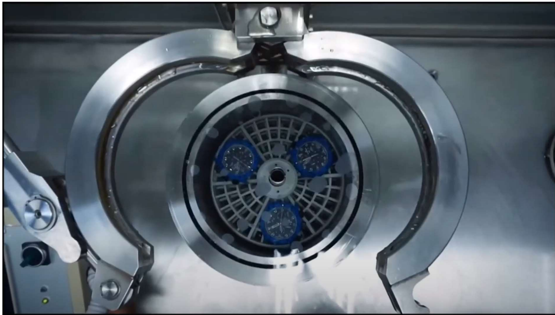
Slika 12. Prikaz umetanja više satova u tlačnu komoru [7]
