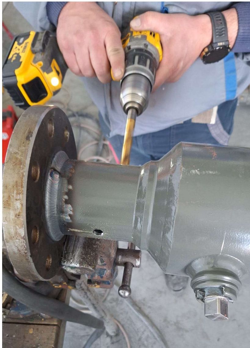
Slika 24. Izrada provrta za priključke s Whitworthovim navojem
