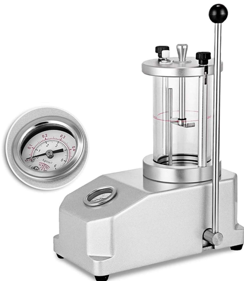
Slika 6. Uređaj za ispitivanje vodonepropusnosti satova do 6 bar [4]
