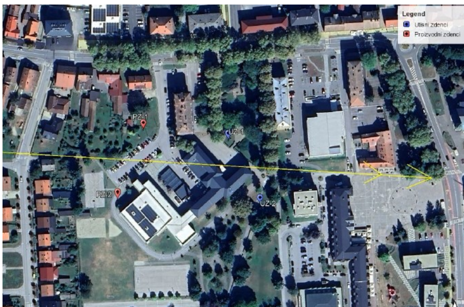
Slika 27. Predloženi položaj proizvodno-utisnih parova zdenaca uz naznačen smjer kretanja podzemne vode (žuto) [24]
