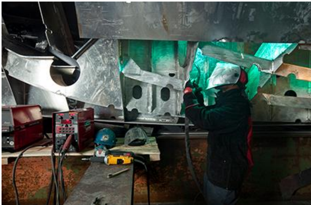
Slika 7. Zavarivanje brodske oplata MIG postupkom [5]
