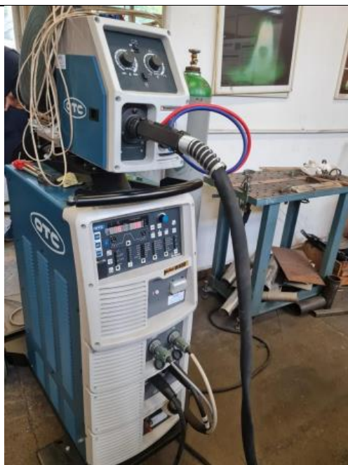
Slika 34. Uređaj za zavarivanje Welbee W400
