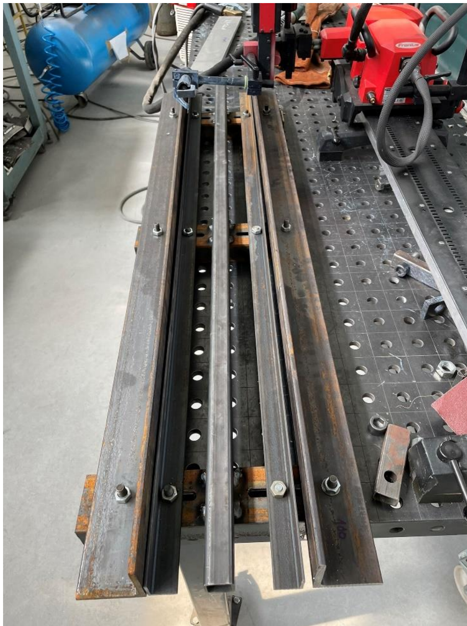
Slika 39. Naprava za stezanje pripremljena za zavarivanje
