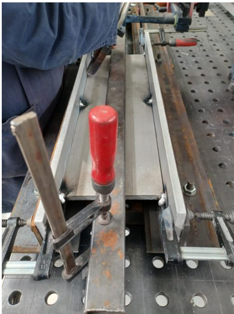
Slika 40. Stezanje probnog uzorka
