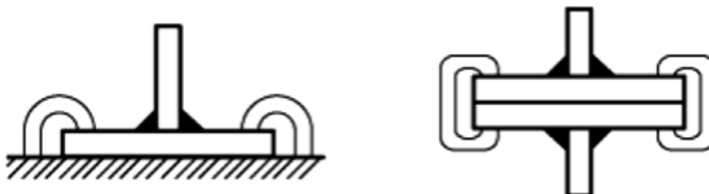
Slika 31. Primjena steznih naprava [28]
