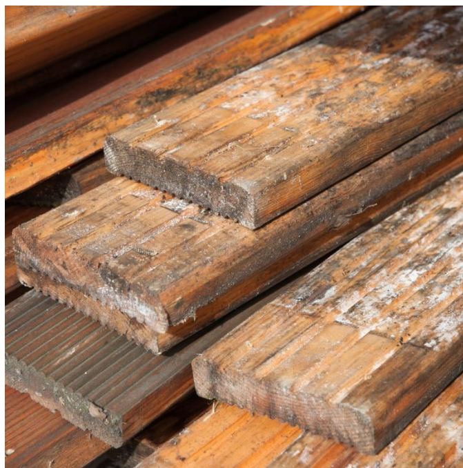
Slika 12. Plijesan na površini drvnih proizvoda [20]
