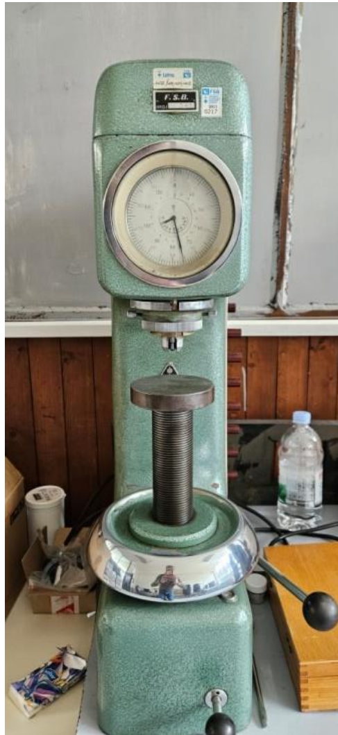
Slika 31. Uredaj za ispitivanje tvrdoće metodom po Brinellu
