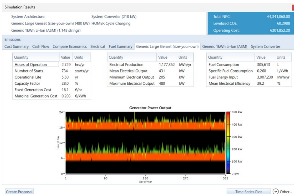
Slika 22 Izlazni podaci o glavnom dizel generatoru
